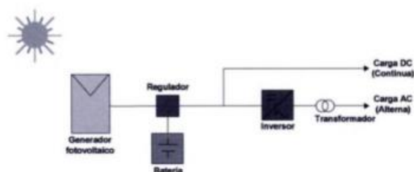
Fig. 6 Estructura de un sistema fotovoltaico. [2]
