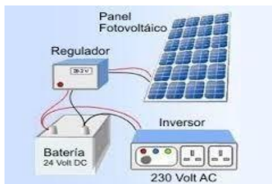
Fig. 14 Esquema de funcionamiento de un regulador solar. [10]
