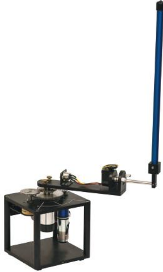
Figure 4: Péndulo rotacional invertido Fuente: Tomado de Quanser (2021)
