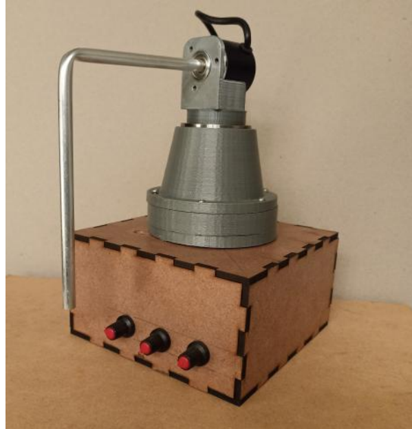
Figure 57: Resultado péndulo rotacional invertido Fuente: Autoría propia
