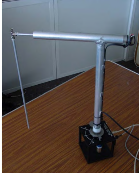
Figure 3: Modelo de péndulo de furuta Fuente: Tomado de Valera et al. (2002)
