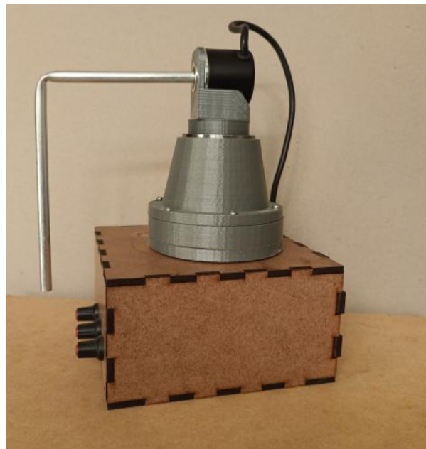
Figure 56: Resultado péndulo rotacional invertido
