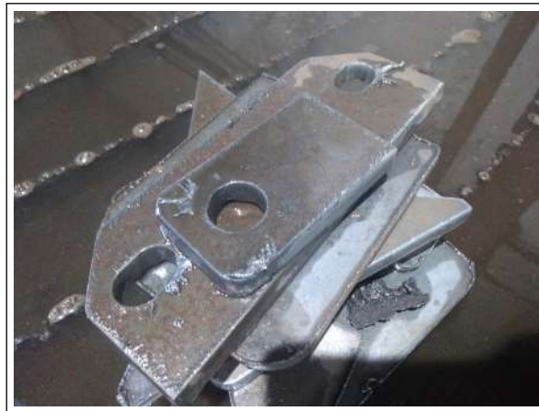
Figura 4.3: Residuos por corte plasma. [Autor].
