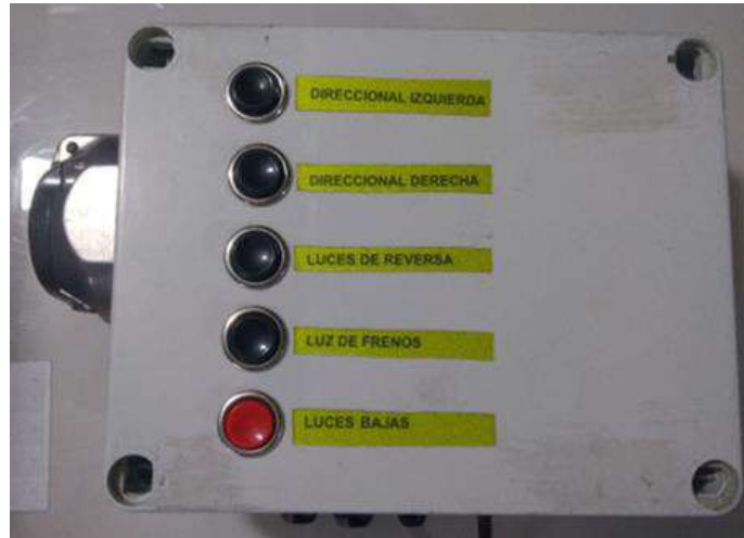
Figura 5: Dispositivo conector hella hembra, para prueba de luces tráiler [Autor]
