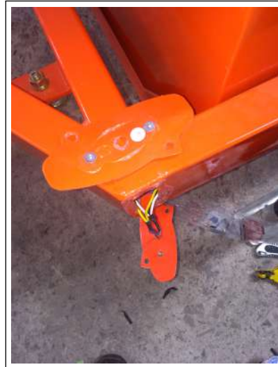
Figura 6.2: Proceso de reinstalación de luz direccional .
