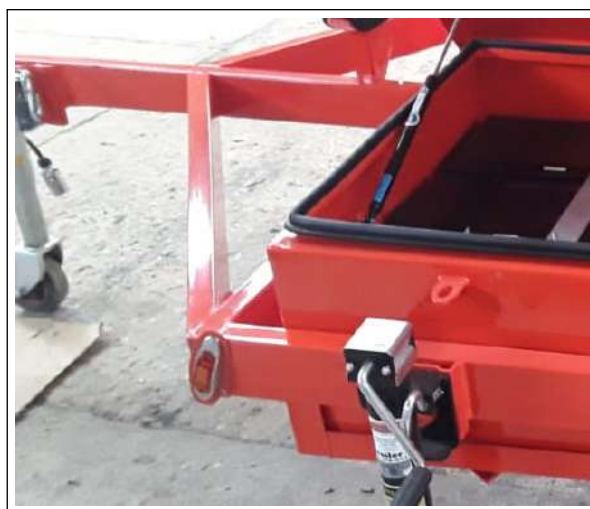
Figura 6.3: Luz direccional reinstalada.
