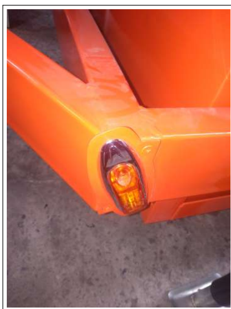
Figura 6.1: Luz direccional mal instalada. [Autor].
