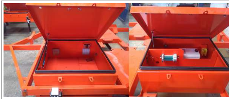
Figura 2.5: Compartimientos baterías y sistema hidráulico.
