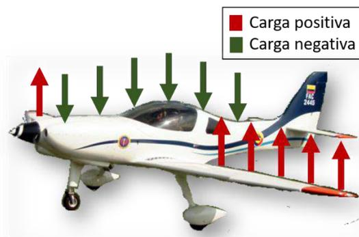
Figura 79. Aplicación de cargas CALIMA T-90<sup>91</sup>
