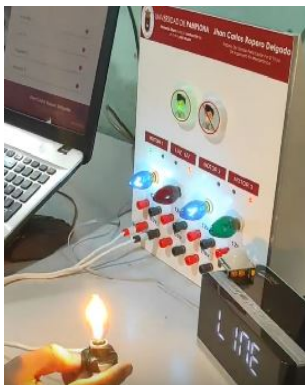
Figura 5.8: Carga de 110v Conectada a la Salida de Voltaje.
