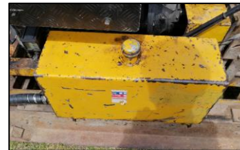
Deposito de aceite hidráulico en máquina.
