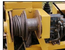
Motor acoplado a tambor en soporte lateral en C.
