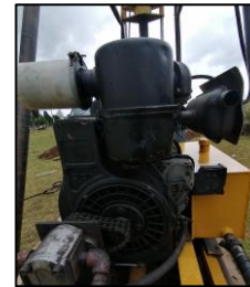
Filtro de aire y cilindro de aceite adaptado.
