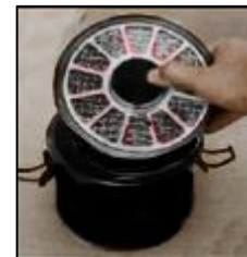
Verificación y retiro masa filtrante (desgaste marca roja).
