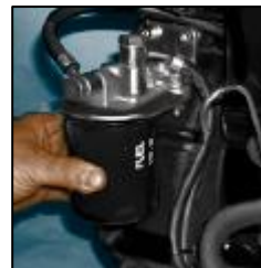
Extracción y recambio de filtro.
