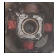
Estator -alternador. Mantenimiento.
