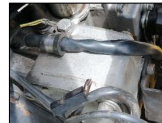
Cableado de 3 pines (alternador), soporte y terminales regulador.
