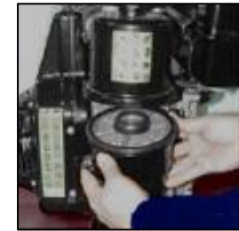
Disposición lateral y extracción filtro de aire, parte inferior.
