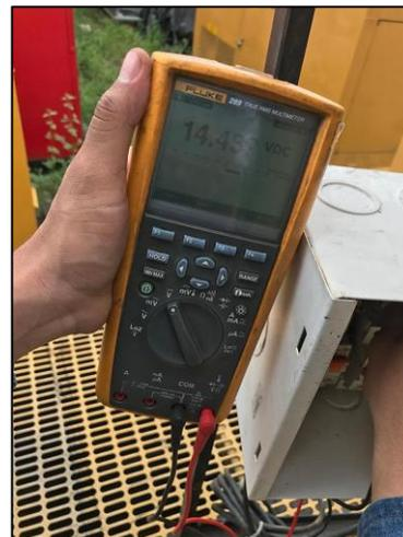
**Fig. 3.46** Medición de voltaje en la salida del panel solar(Autor).
