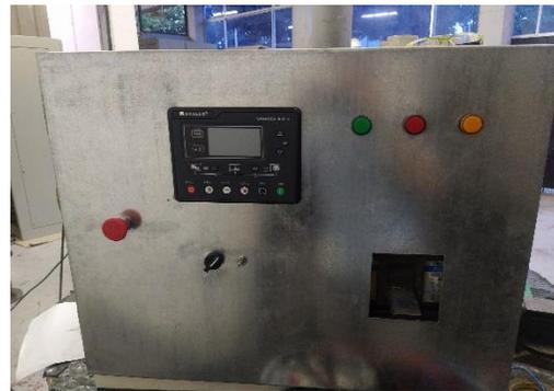
**Fig. 3.11** Instalación de componentes en la tapa del armario eléctrico(Autor).
