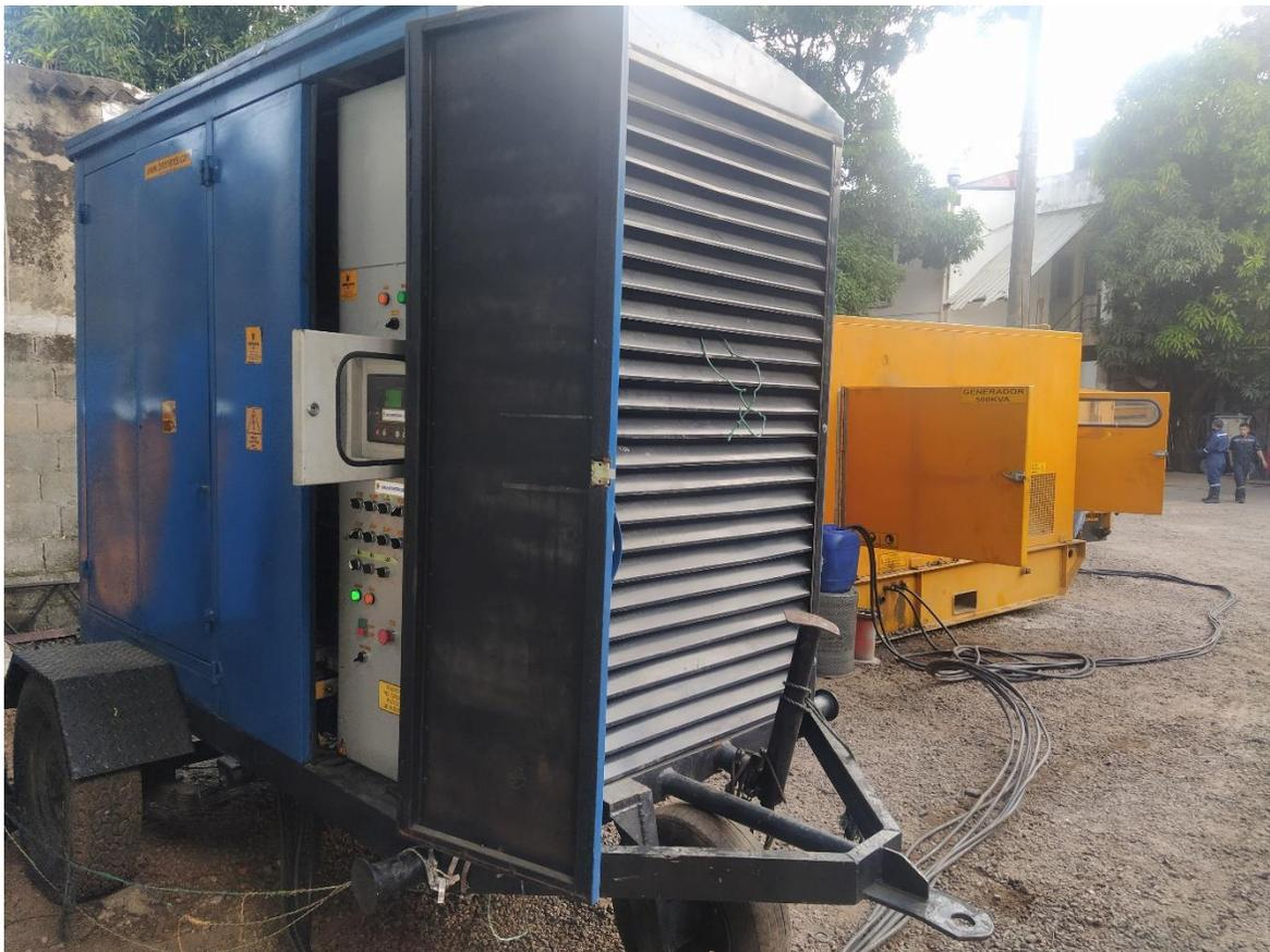
*Fig. D.1: Pruebas de carga con banco de resistencia (AUTOR)*
