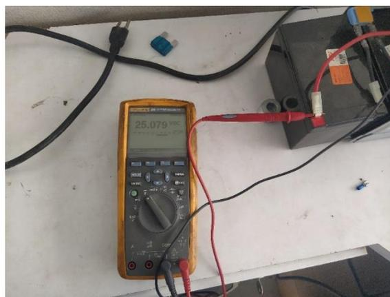
*Fig. 3.5 Verificación de la carga de las baterías(Autor).*
