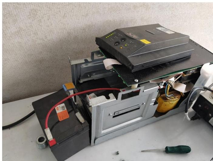
*Fig. 3.3 Pruebas con baterías a la UPS(Autor).*
