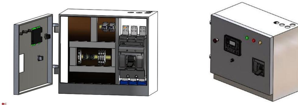
**Fig. 3.8** Distribución de elementos internos del armario eléctrico(Autor).
