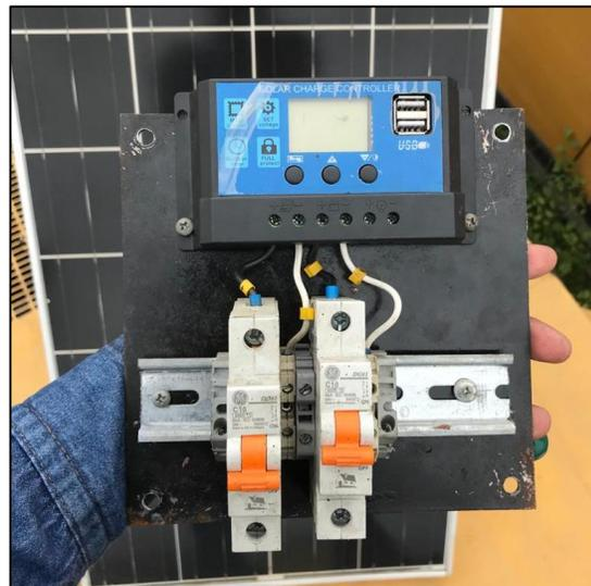
*Fig. 3.42* Instalación de modulo solar charge componentes(Autor).
