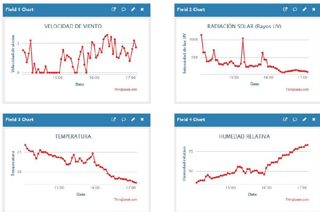
Figura 35: Interfaz IoT de ThingSpeak para visualización de variables ambientales.
