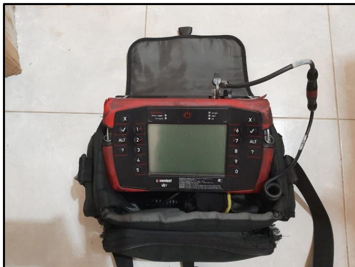
Figura 14. Fotografía del analizador de vibraciones perteneciente a la empresa. Elaboración propia
