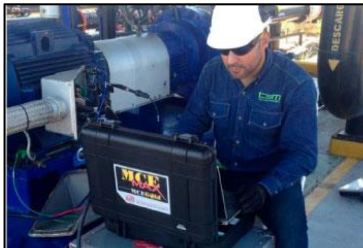
Figura 18. Análisis MCEmax a un motor eléctrico. Tomada de (TSM COLOMBIA, 2015)
