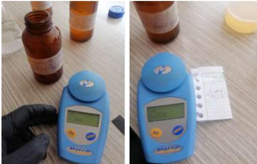
Figura 112 y 113. Valor refractómetro (0%- 1,3481)/ (1,5% -1,3328.) . [ING FIRE]
