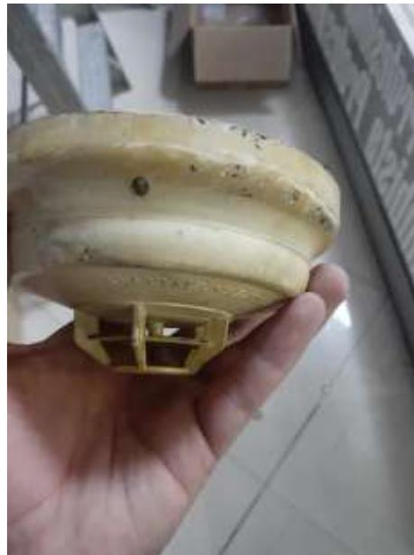
Figura 51. Sensor térmico encontrado en el techo de Creeps. [ING FIRE]
