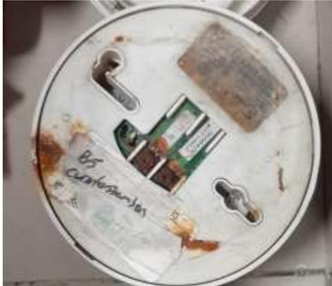
Figura 10. Detector de humo corroído. [ING FIRE]
