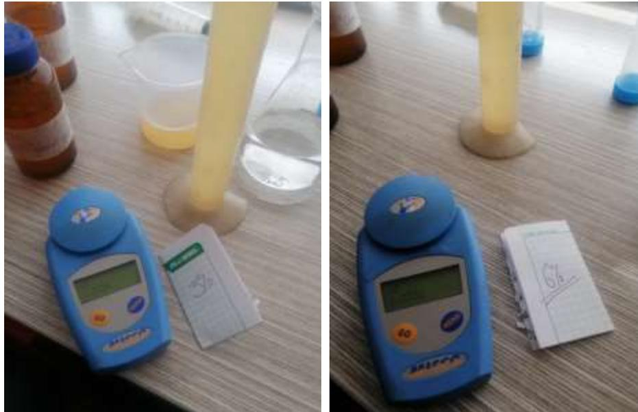
Figura 114. Valor refractómetro (3%- 1,3329)/ (6.0% -1.3331) . [ING FIRE]
