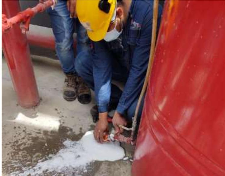
*Figura 106. Toma de muestras del dosificador. [ING FIRE]*
