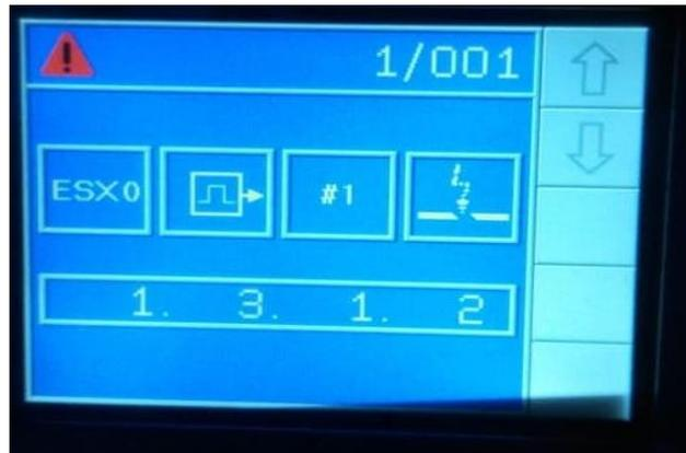
**Figura 7.13** Errores en pantalla de control de grúa.
