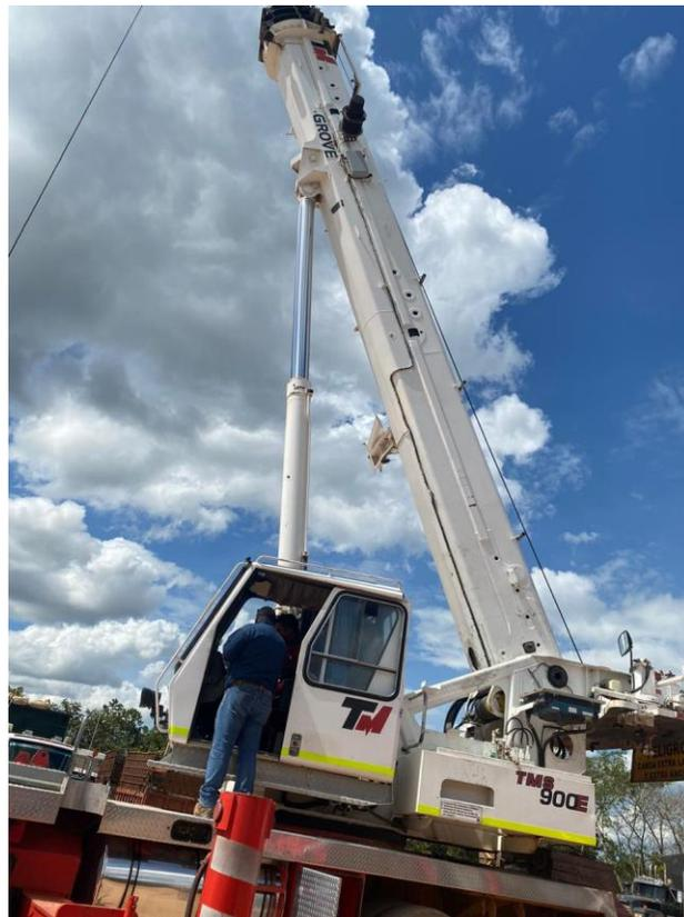
**Figura 5.11** Pruebas de funcionamiento grúa 90ton.
