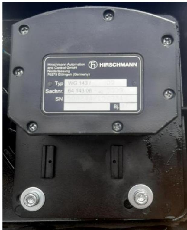
*figura 4.94* Sensor de ángulo de grúa con salida en corriente.
