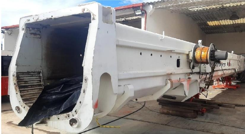
*Figura 5.2 Desmonte pluma grúa 210ton.*
