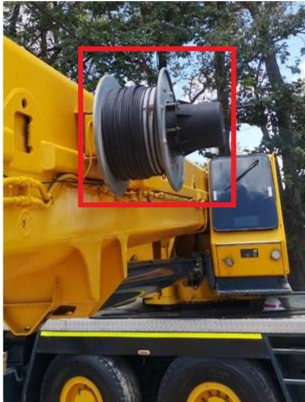
**Figura 4.96** Transmisor de longitud de grúa.
