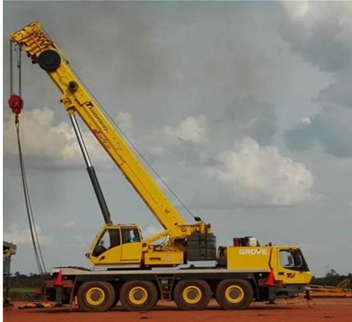
*Figura 2.10* Grúa de 75 ton. con pluma retraída.
