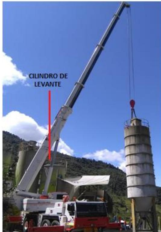
*Figura 4.44 Cilindro de levante grúa cap. 100ton transportes Montejo.*
