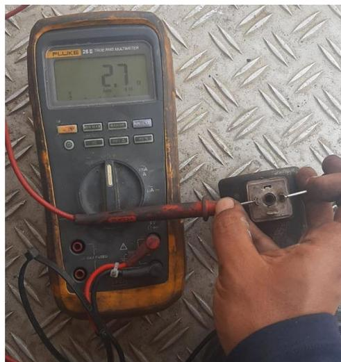
*Figura 5.17 Pruebas a bobinas grúa 240ton.*
