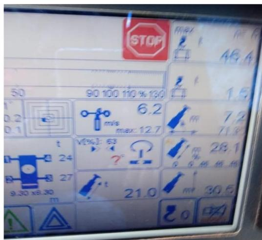
**Figura 7.14** Fallos en LMI por sensores.
