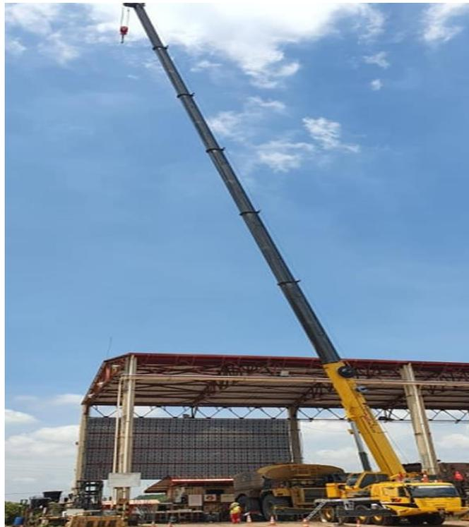
*Figura 2.11* Grúa de 115 ton. Telescopada.
