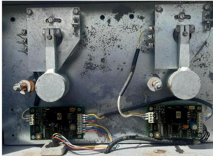
*Figura 4.93* Sensor de ángulo de grúa con salida en voltaje.
