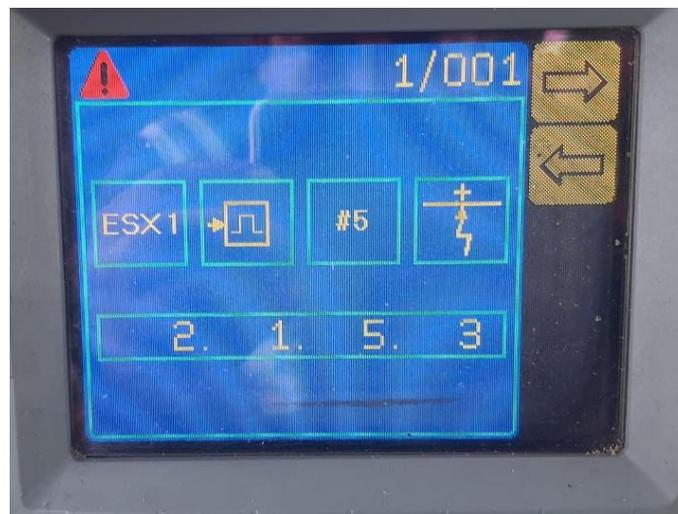
*Figura 5.8 Error en S2112N, pantalla de control grúa 90ton.*
