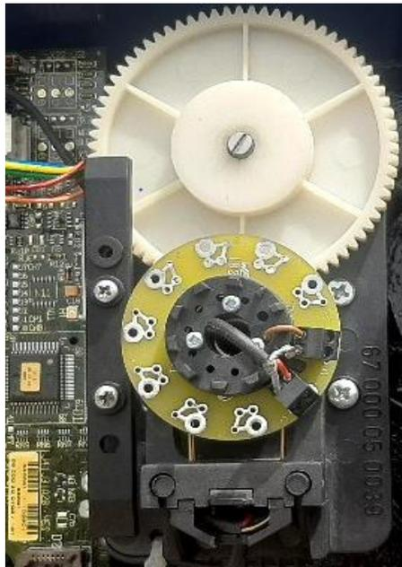
*Figura 4.95 Potenciómetro de longitud de grúa.*
