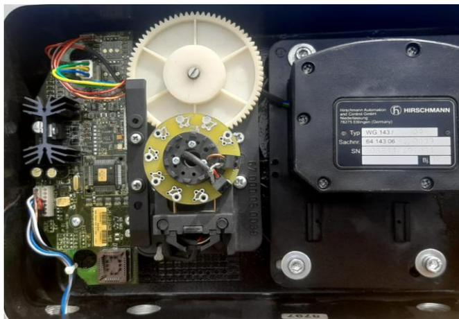
*Figura 5.12 Sensor de ángulo y longitud LMI grúa de 80ton.*
