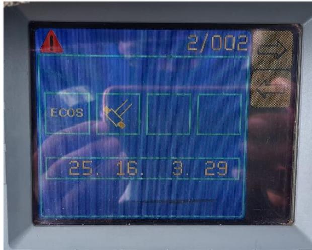
**Figura 5.10** Fallos en sensor de longitud, pantalla de control grúa 90ton.
