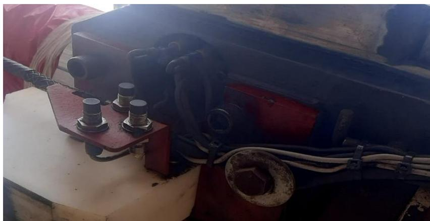
*Figura 5.4 Cambio y calibración de sensores del telescópico.*
