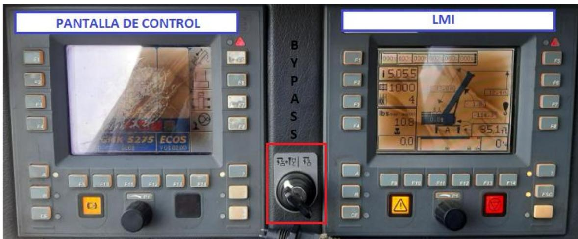
**Figura 4.90** Pantalla de control y LMI grúa 275ton.
