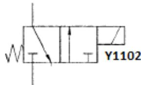
***Figura 4.76 Diagrama válvula Y1102.***
