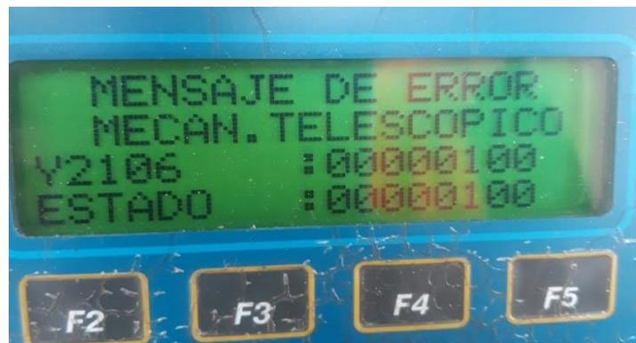
*Figura 5.16 Fallo en bobina de levante de pluma.*
