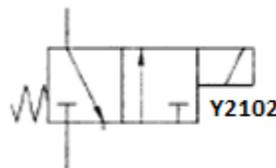
**Figura 4.55** Diagrama de válvula Y2102.
