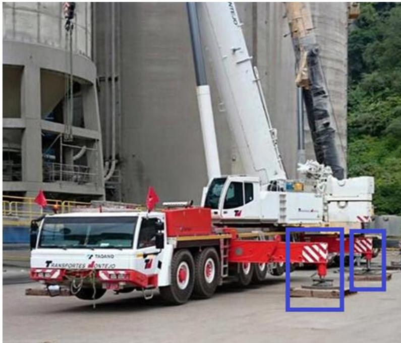
**Figura 2.9** Grúa 400 ton, con estabilizadores de anclaje.
