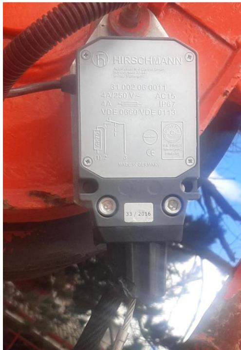
**Figura 4.98** Sensor de anti two block grúa.
