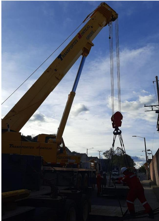
*Figura 5.14 Pruebas de calibración grúa 80ton.*
