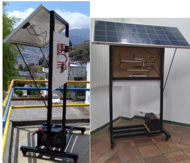
Figura 51. Resultado construcción del mecanismo de inclinación
