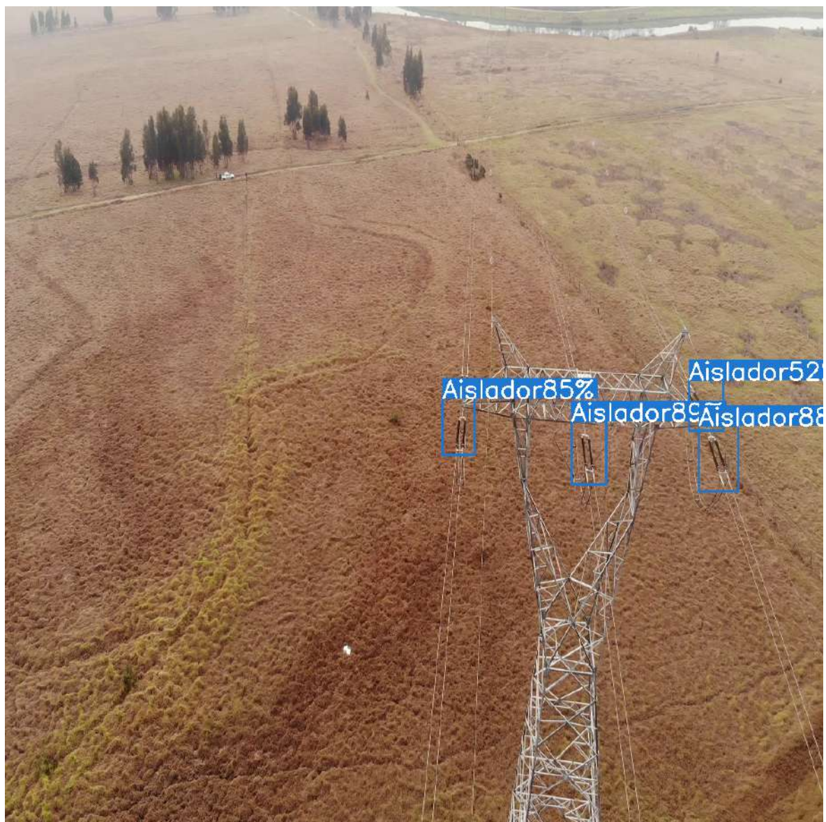
Figura C.3: Aplicación del algoritmo de detección de aisladores eléctricos (Detección 3)
