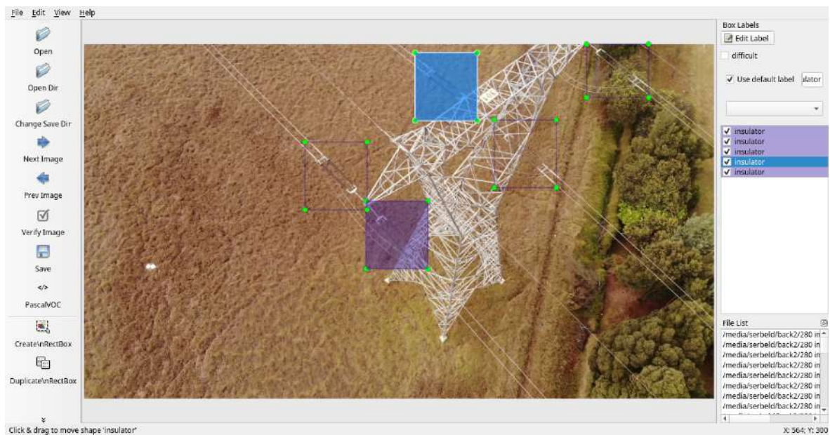
Figura B.7: Visualización de la imagen 1 del dataset de infraestructuras eléctricas tomada en la ciudad de Bogotá para la detección de aisladores eléctricos usando el software LabelImg
