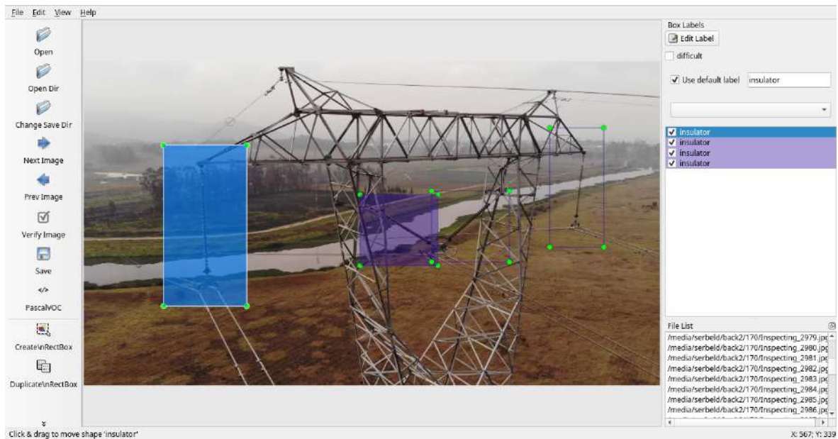
Figura 5.6: Visualización de imágenes del dataset de infraestructuras eléctricas tomada en la ciudad de Bogotá para la detección de aisladores eléctricos usando el software LabelImg
