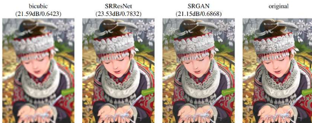
Figura 7.1: De izquierda a derecha: interpolación bicúbica, red residual profunda optimizada para MSE, red adversa generativa residual profunda optimizada para una pérdida más sensible a la percepción humana, imagen original de recursos humanos. (Un escalado hasta 4 veces el tamaño original)
