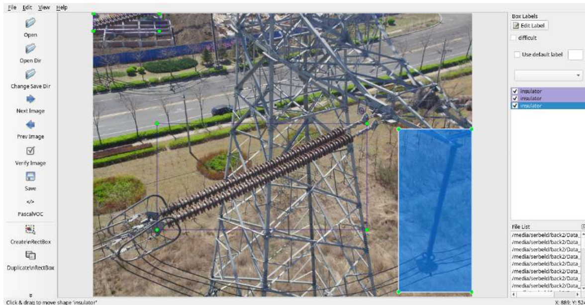
Figura 5.5: Visualización del dataset para la detección de aisladores eléctricos verticales usando el software LabelImg
