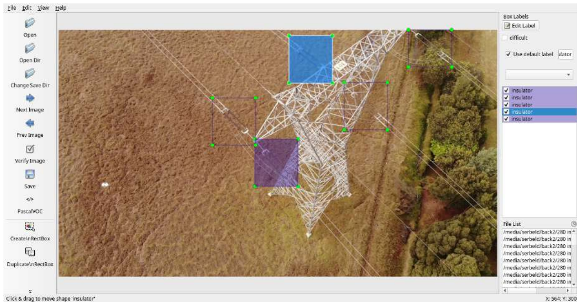
Figura 5.7: Visualización de imágenes del dataset de infraestructuras eléctricas tomada en la ciudad de Bogotá para la detección de aisladores eléctricos usando el software LabelImg
