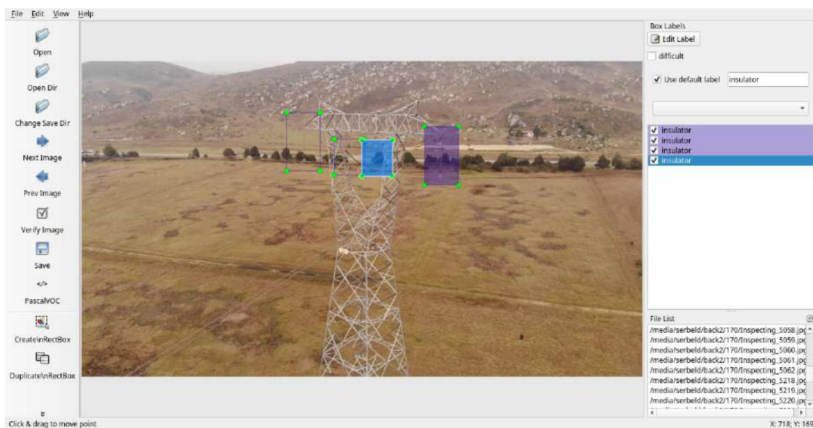
Figura B.9: Visualización de la imagen 3 del dataset de infraestructuras eléctricas tomada en la ciudad de Bogotá para la detección de aisladores eléctricos usando el software LabelImg
