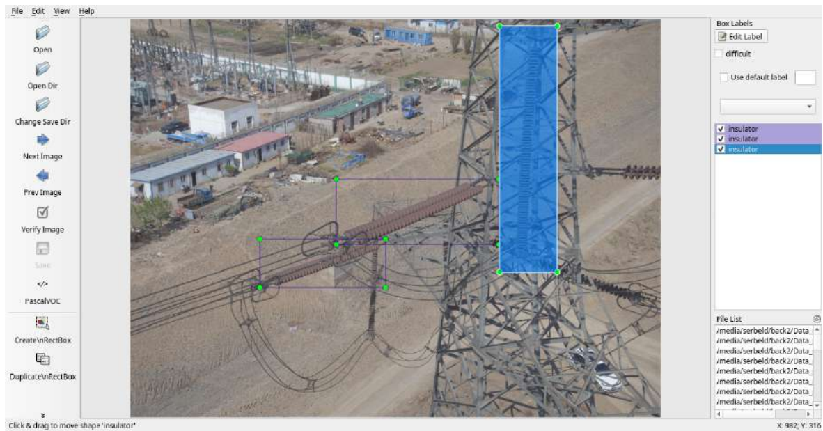
Figura B.6: Visualización de imágenes del dataset para la detección de aisladores eléctricos verticales usando el software LabelImg (Vista 6)
