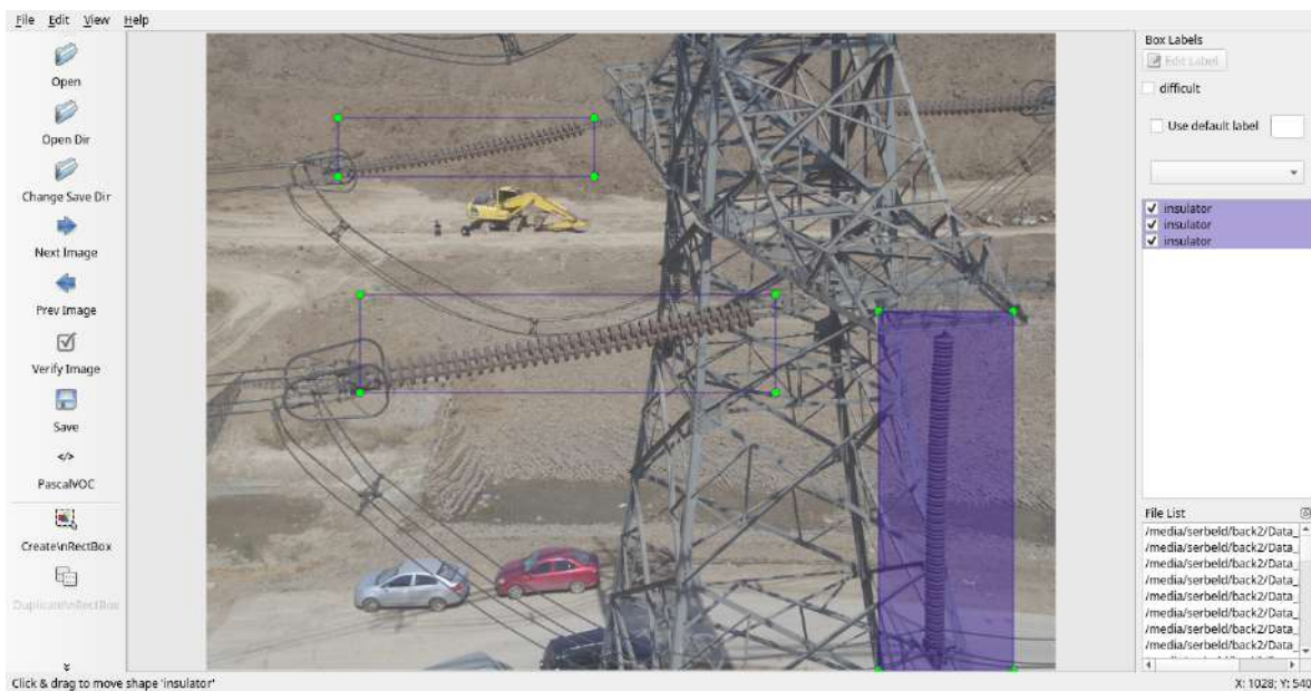
Figura B.5: Visualización de imágenes del dataset para la detección de aisladores eléctricos verticales usando el software LabelImg (Vista 5)
