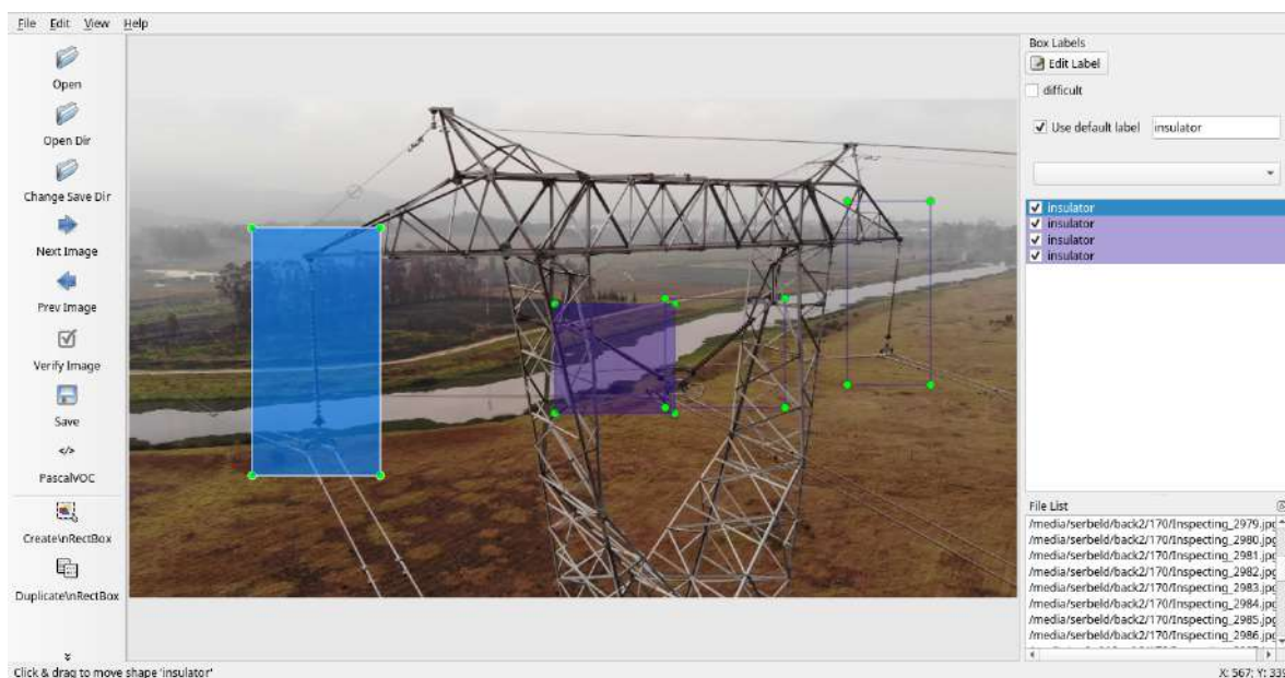
Figura B.8: Visualización de la imagen 2 del dataset de infraestructuras eléctricas tomada en la ciudad de Bogotá para la detección de aisladores eléctricos usando el software LabelImg
