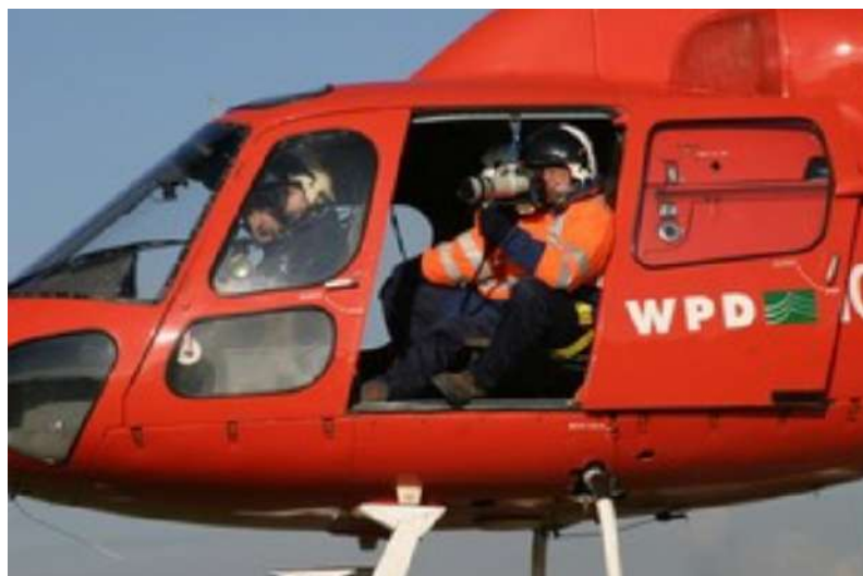
Figura 3.13: Adquisición del vídeo de inspección en infraestructuras eléctricas hace 20 años atrás
