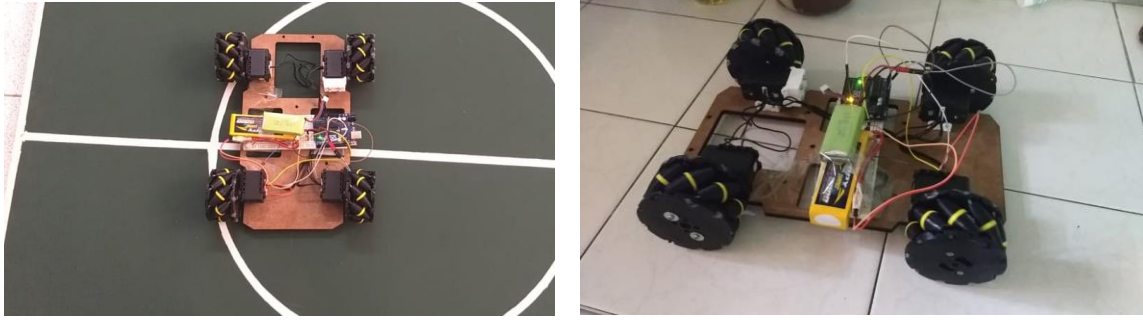
Figura 63. Prueba de movimiento con ARDUINO - Programación de movimientos. (Autor)
