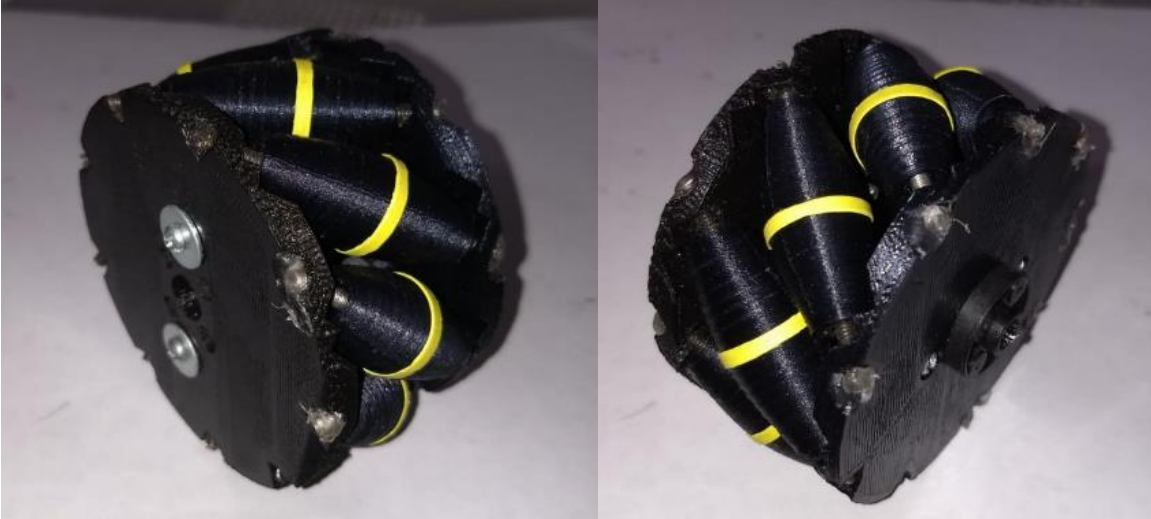
61. Prototipo final de la llanta holonómicas, con aros de caucho. (Autor)
