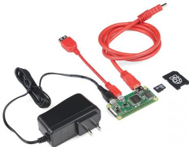
Figura 41. Periféricos y adaptadores para la Pi Zero W (Sparkfun, 2018)
