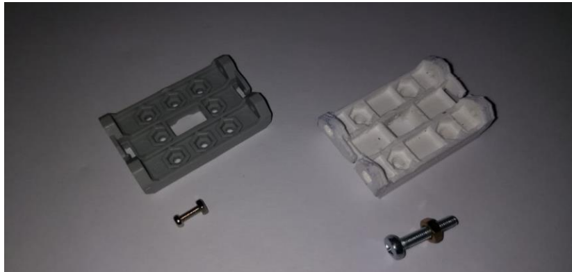
Fig. 2. Derecha: Impresión del soporte FP04F2 rediseñado. Izquierda: soporte FP04F2 original. (Autor)
