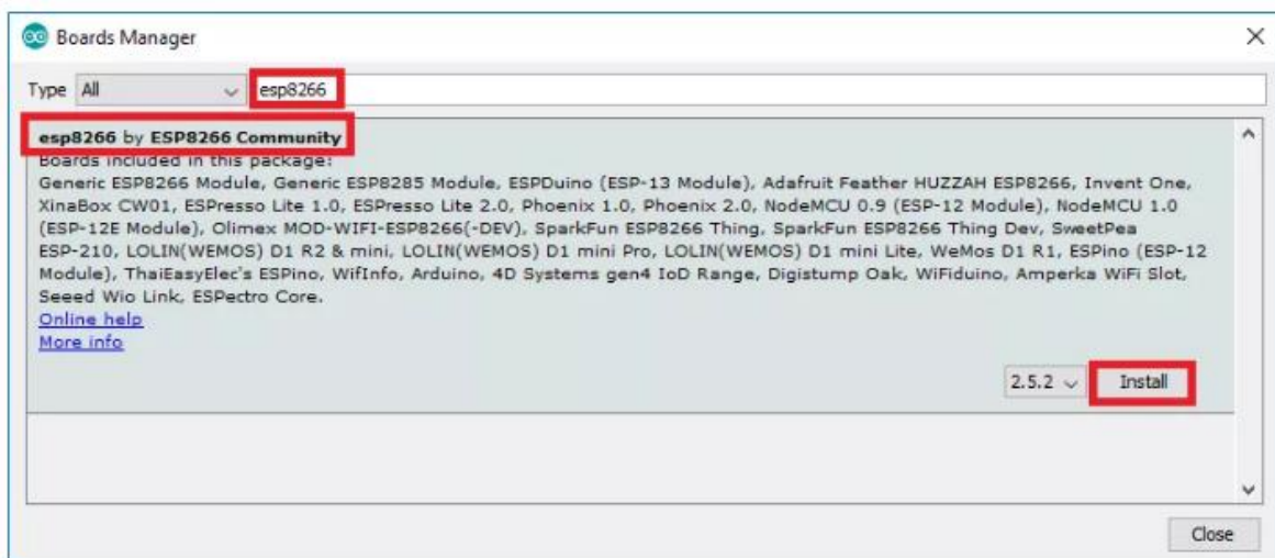
Figura 81. Instalación ESP8266 en Arduino (paso 4)
