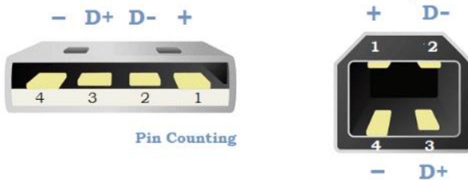
Figura 26. Las 4 líneas y tipos de USB (“Communication Protocols in Embedded Systems - Types, Advantages & Disadvantages,” 2018)
