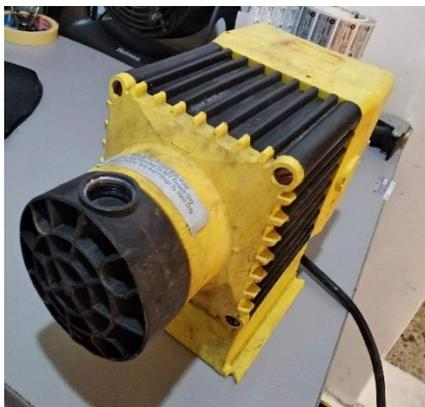
*Fig. 3.35 Bomba de Dosificación En estado de deterioro. (Autor)*
