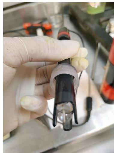
*Fig. 2.10 Electrodo de vidrio para medición de pH. (Autor).*
