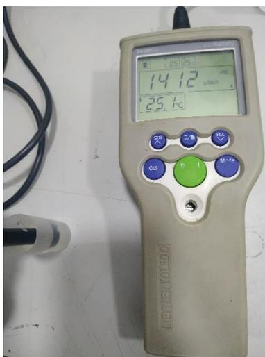
**Fig. 3.18** Calibración en 1413  $\mu\text{S}/\text{cm}$ . (Autor)
