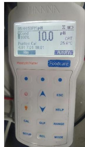
**Fig. 3.16** Calibración en pH 10.00. (Autor)
