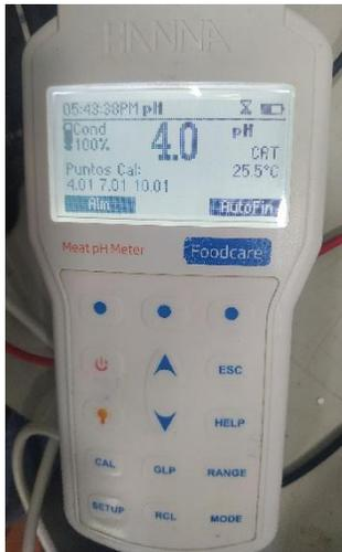
**Fig. 3.14** Calibración en pH 4.00. (Autor)
