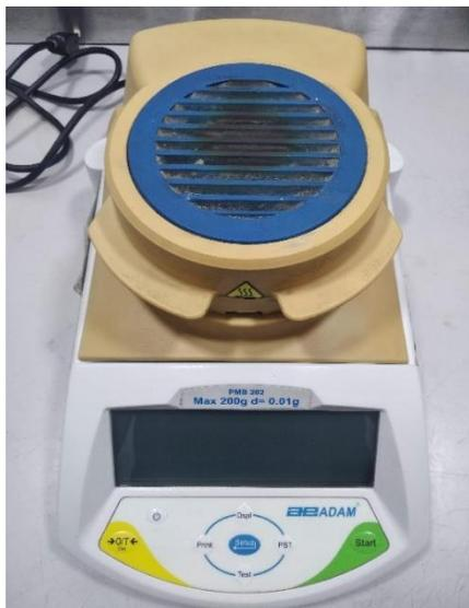
**Fig. 3.5** Balanza para análisis de Humedad.
