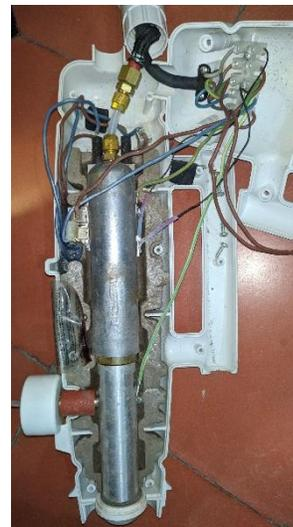
**Fig. 3.55** Pistola de calentamiento para salida de vapor. (Autor)
