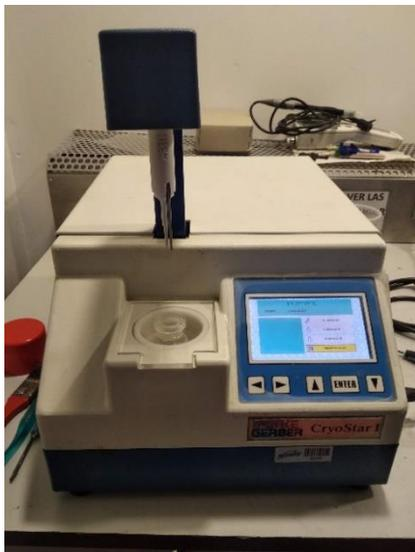
**Fig. 3.3** Crioscopio FUNKE GERBER Cryostar I. (Autor).
