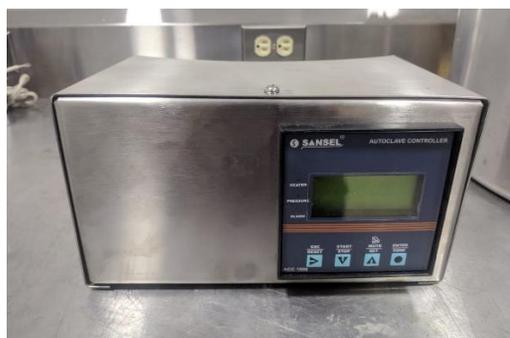
*Fig. 3.29 Nuevo diseño para el sistema de control digital. (Autor).*
