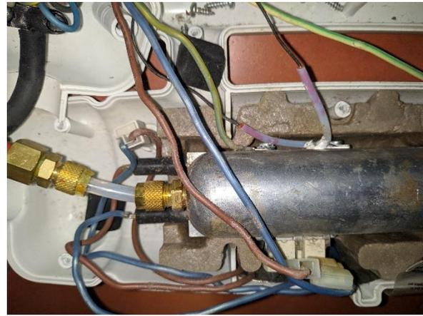
*Fig. 3.61 Sistema de calentamiento de la pistola de Vapor. (Autor)*
