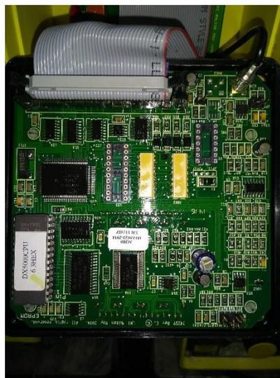
**Fig. 3.46** *Tarjeta controladora del Sistema de Dosificación. (Autor)*
