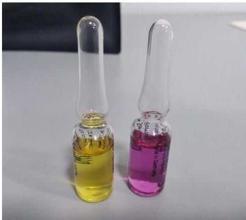
*Fig. 3.34 Indicadores biológicos para proceso de esterilización. (Autor)*
