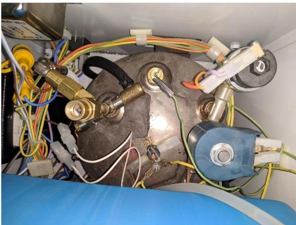
**Fig. 3.54** Sistema de Calentamiento de equipo Sani-Vapor versión I. (Autor)
