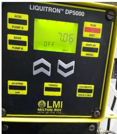
*Fig. 3.47 Calibración de pH en Solución de pH 7.01. (Autor)*
