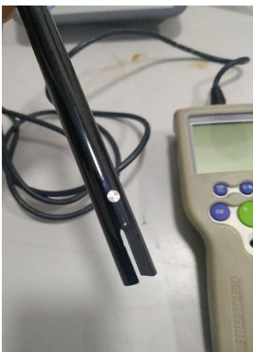
**Fig. 3.17** Electrodo de Conductividad METTLER TOLEDO. (Autor)
