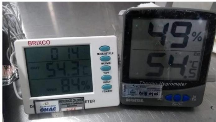
*Fig. 3.13 Calibración de Termo-higrómetro. (Autor).*
