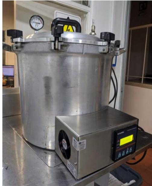
**Fig. 3.32** Funcionamiento del Autoclave con Sistema de control digital. (Autor).
