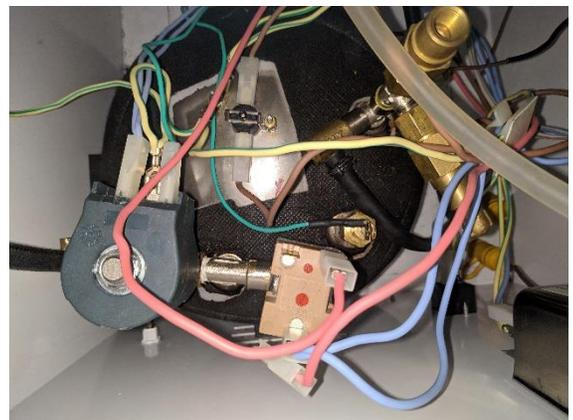
**Fig. 3.59** Sistema de calentamiento del equipo Sani-Vapor II. (Autor)
