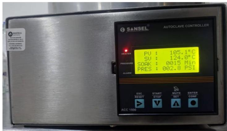
**Fig. 3.33** Visualización de datos en Controlador digital de Temperatura. (Autor)
