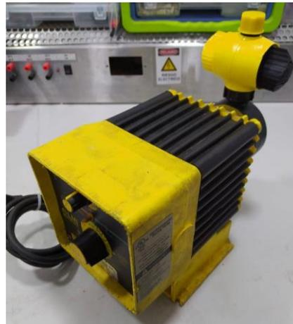
*Fig. 3.40 Restauración de Bomba con Sistema de Dosificación. (Autor)*
