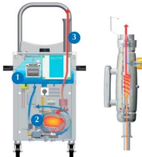
*Fig. 3.51 Funcionamiento de Sani System Polti Check Versión II. [42]*
