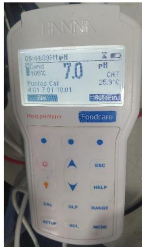
**Fig. 3.15** Calibración en pH 7.00. (Autor)
