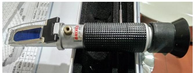
**Fig. 3.21** Refractómetro Análogo BRIXCO de 0 – 85% Brix. (Autor).
