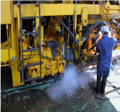
*Fig. 2.11 Desinfección con vapor Saturado. [41]*
