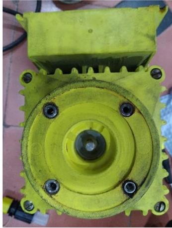
*Fig. 3.37 Estado de oxidación de tornillos De Sujeción. (Autor)*
