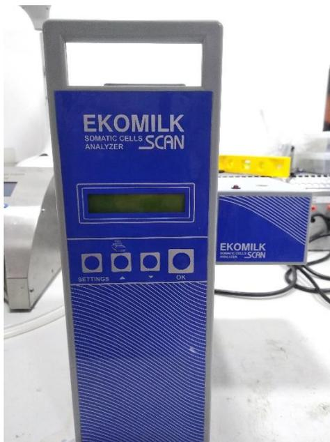
**Fig. 3.10** Analizador de Células Somáticas. (Autor).
