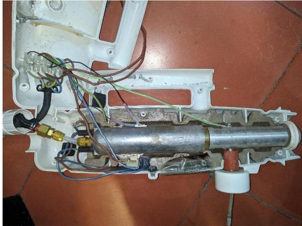
*Fig. 3.60 Sistema completo de calentamiento De pistola de vapor saturado. (Autor)*
