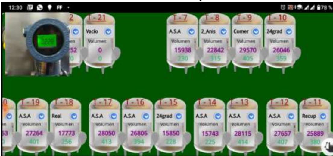
El nivel del tanque posee una columna de líquido de aguardiente 24°, de tal manera que la presión ejercida por este líquido, al Transmisor Indicador de Nivel en el tanque 15 es de 228 y el volumen ara la densidad de este producto es 15850 Lt.
