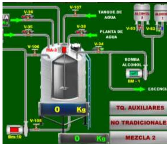
En la figura 107, la bomba 10 está cerrada, mientras que la bomba 1, se mantiene operando.
