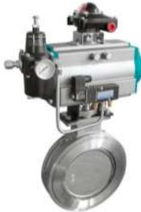
Este tipo de válvulas suelen ser muy robustas y debido que el control de la apertura o cierre de éstas se le otorga a una válvula 5/2 (5 puntos de conexión, 2 estados), la cual se control mediante una bobina o relay electromecánico, este se puede controlar fácilmente desde un PLC. Estas serán las electroválvulas que se proponen en el proyecto, quienes operarán simultáneamente con las bombas y agitadores para llevar a cabo las operaciones en la planta.
