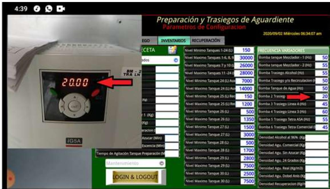
Las flechas de la figura 127, muestran la posibilidad de cambiar estos parámetros internos desde la HMI, de tal manera que se tiene total control sobre el comportamiento de los dispositivos debido a la comunicación Modbus RTU implementada, de esta manera se determina que el sistema de control ha sido un éxito en todas sus etapas de monitoreo y control, no solamente desde la HMI física, sino también desde la virtualizada creada en el cMT-SVR.
