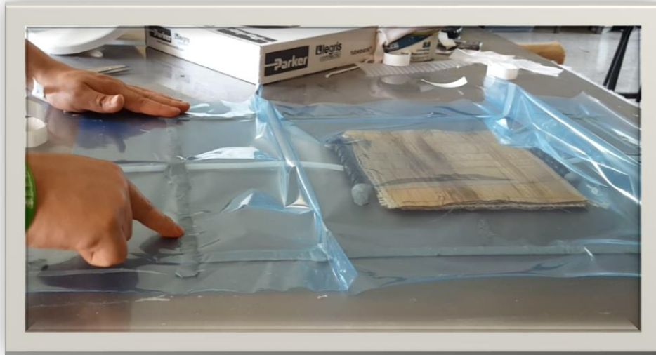
Figura 12. Ilustración fabricación del material por infusión en vacío
