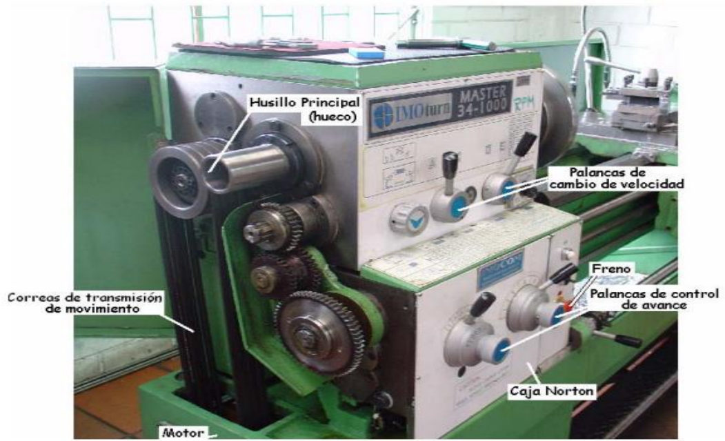
Figura 27: Partes Principales Torno, Caja Norton Fuente: [Escuela Colombiana de Ingeniería Julio Garavito, 2010]
