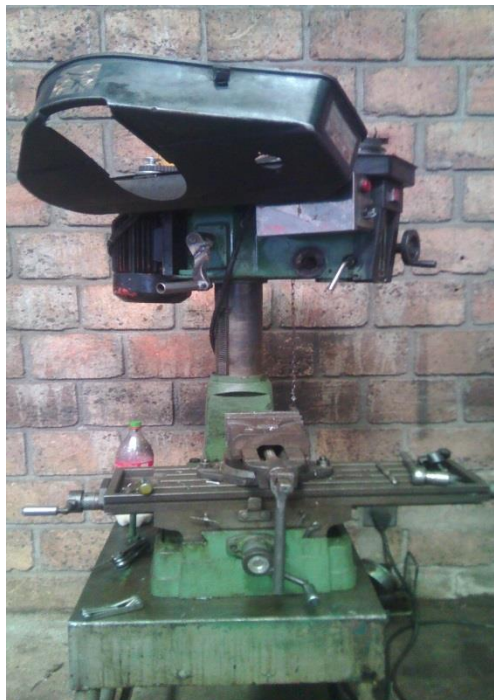
Figura 10: Taladro Vertical Marca RONG FU modelo RF-31. Fuente: (Autor, 2015)
