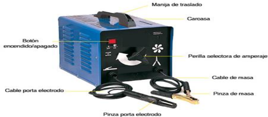
Figura 29: Partes Soldador Eléctrico. Fuente: (DE MÁQUINAS Y HERRAMIENTAS, 2011)
