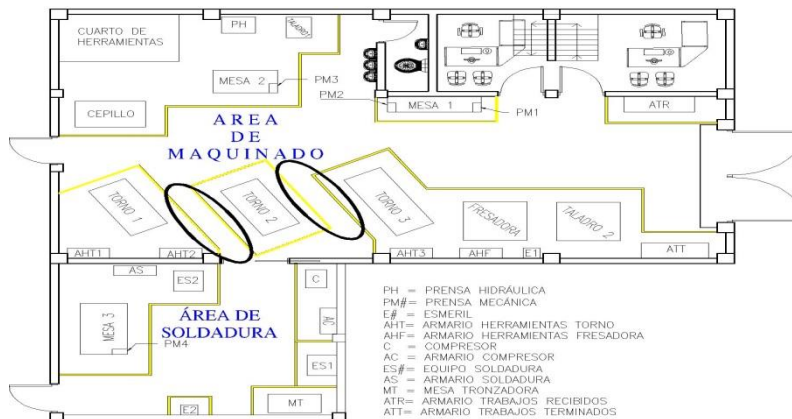
Fig. 1. Distribución actual de la Maquinaria en la Empresa, con diagrama de líneas de circulación.
