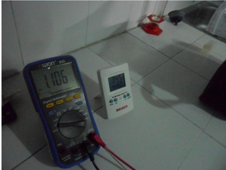
Imagen 20. Medición de temperatura, humedad relativa y voltaje.
