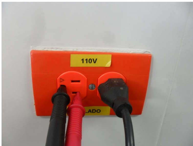
Imagen 45. Medición polo a tierra
