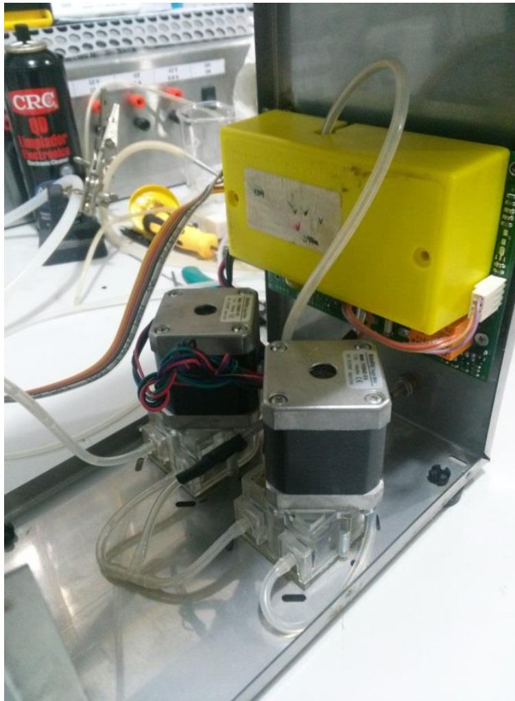
Imagen 13. Bombas peristálticas de la lactoscan.
