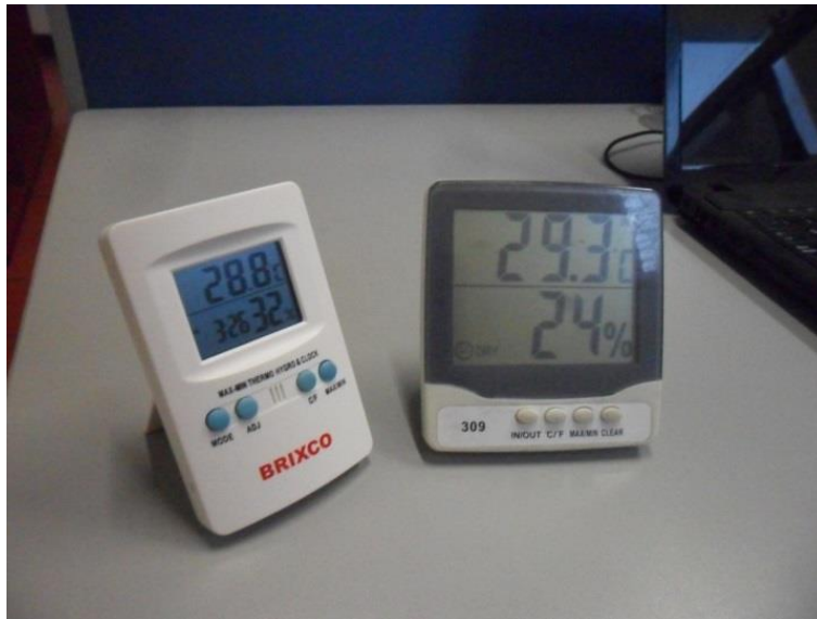
Imagen 16. Error de calibración del termohigrómetro
