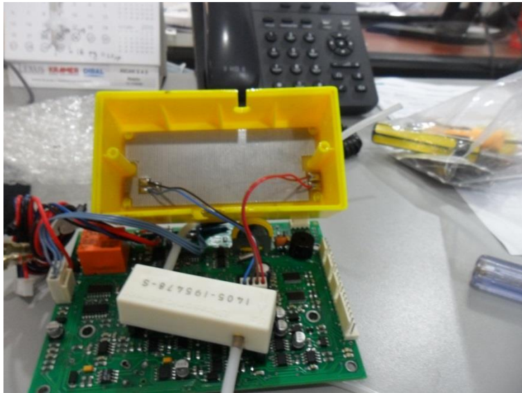
Imagen 11. Sensor ultrasónico LACTOSCAN
