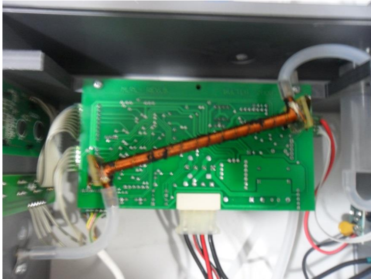
Imagen 9. Sensor ultrasónico EKOMILK
