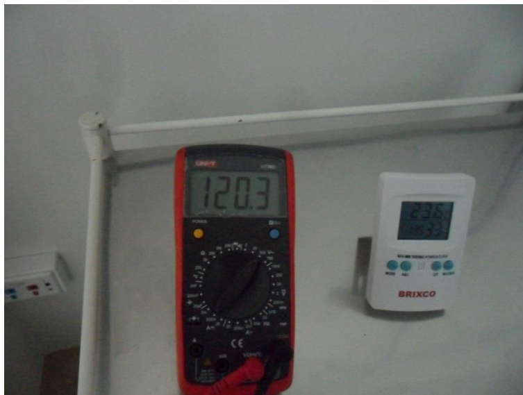
Imagen 31. Medición de la tierra centro lab.
