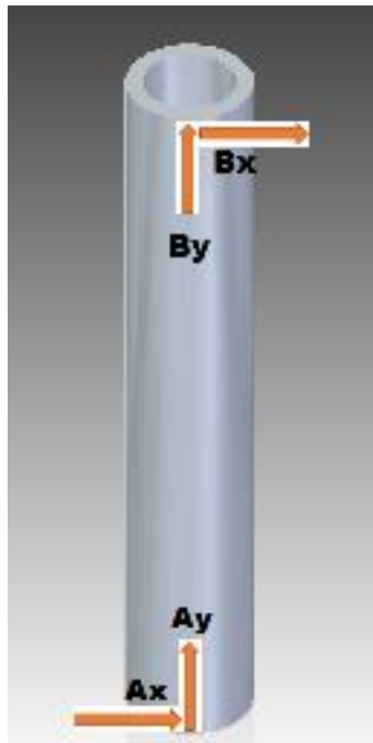
Figura 16 Cálculo de Reacciones en el tubo de acero inoxidable 306-L
