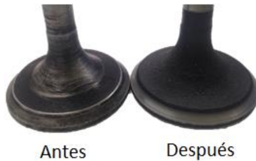
Figura 38. Válvulas antes y después del asentamiento.
