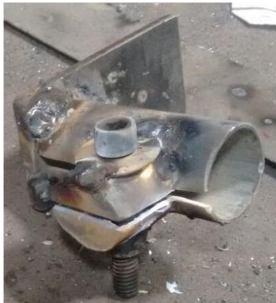
Figura 29 Base soporte de la corredera.
