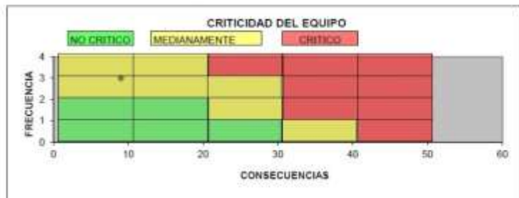
Figura 20. Criticidad motoniveladora CAT 12H
