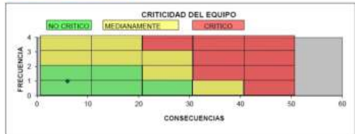
Figura 23. Criticidad compresor de aire tornillo lubricado KAESER M50
