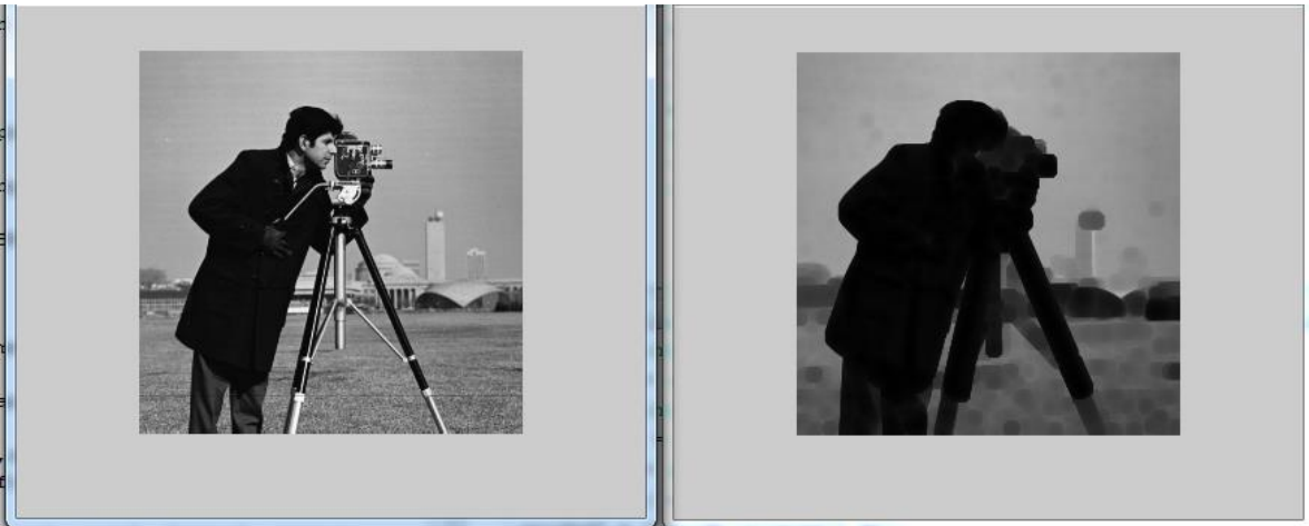
Figura 2 Imagen erosionada en niveles de grises
