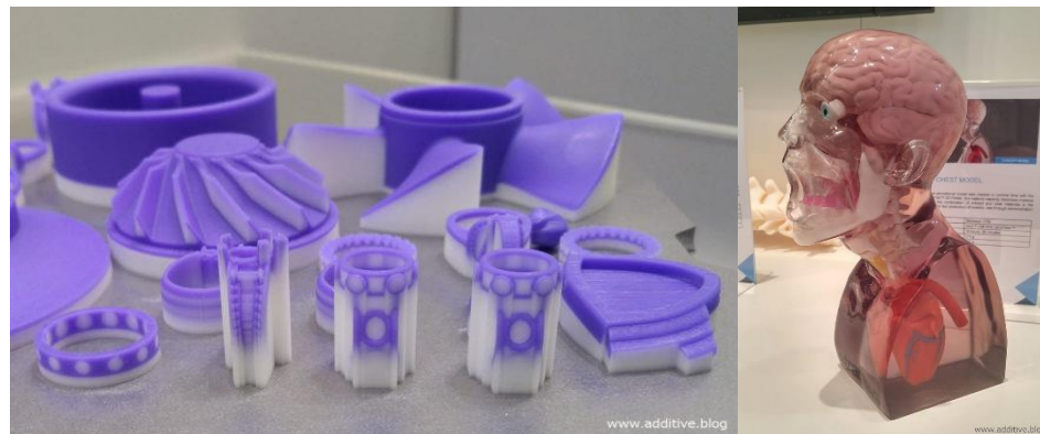
Figura 11 (a) Impresiones Poliyet con materia de soporte (b) Impresión Poliyet con material transparente luego de ser pulido [20].
