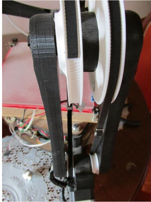
Figura 93 Mecanismo de transmisión con polea sincrónica GT2
