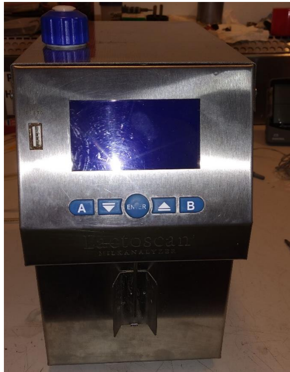
Figura 26. Analizador de leche. Fuente: Elaboración propia.
