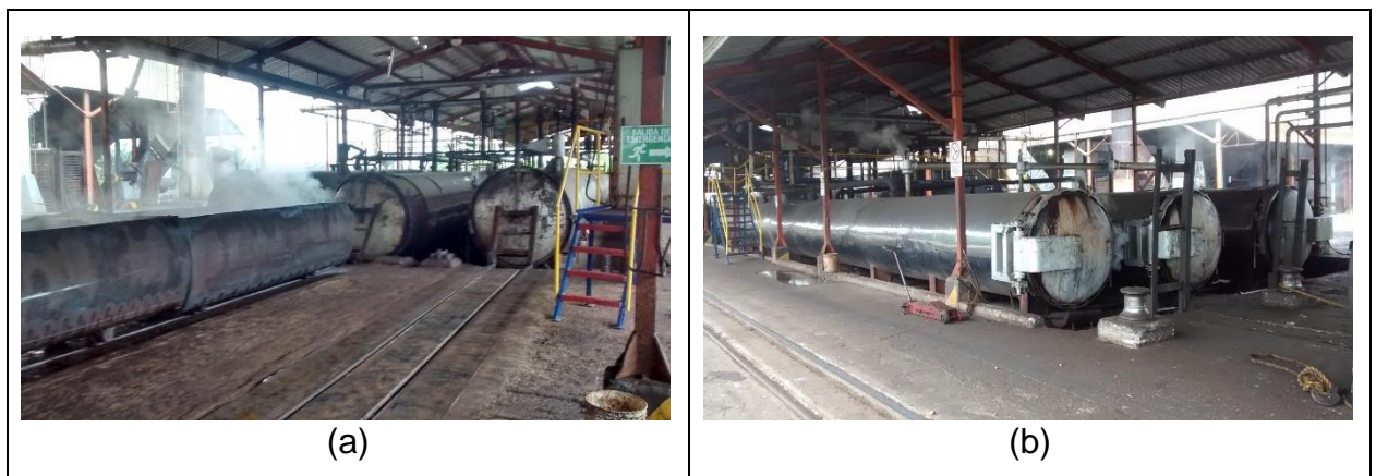
Figura 10. Esterilizadores de la empresa. (a) Salida de vagonetas. (b) Entrada de vagonetas
