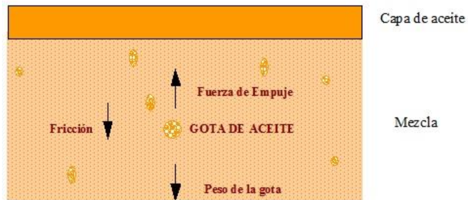
Figura 21. Esquema de clarificación estática
