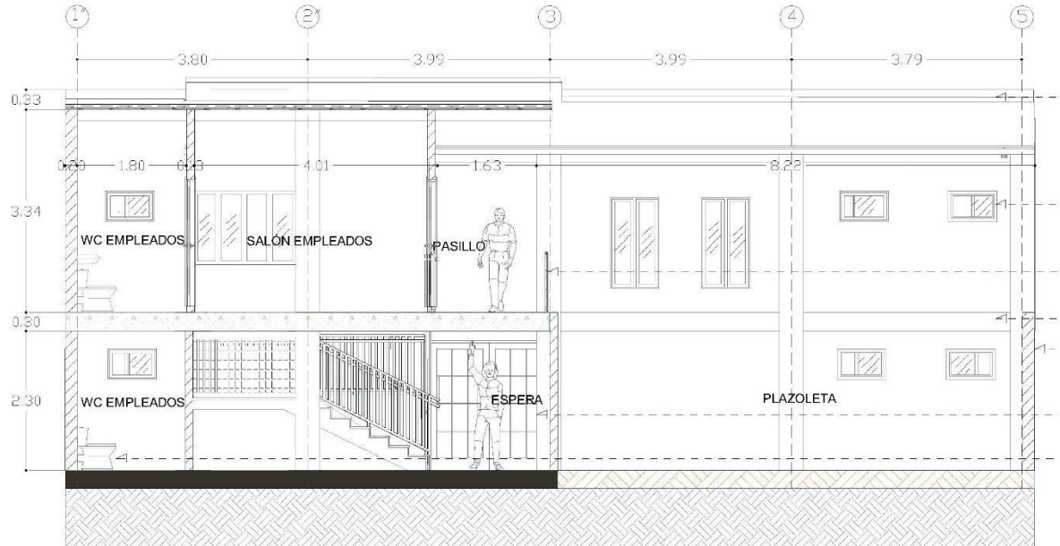
Ilustración 65 Corte trasversal E-E''
