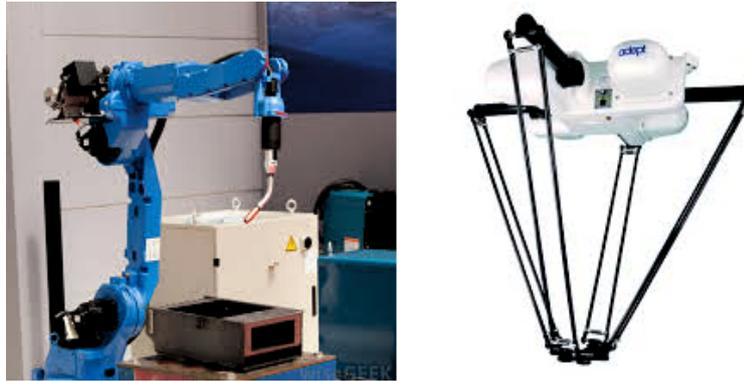
**Figura 2.8:** Robots: Serial vs Paralelo.
