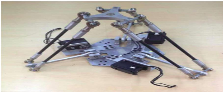
**Figura 5.2:** Armando el Robot Paralelo Delta.
