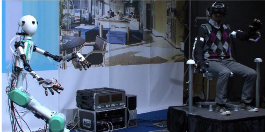
**Figura 2.24:** Teleoperación con traje biométrico.
