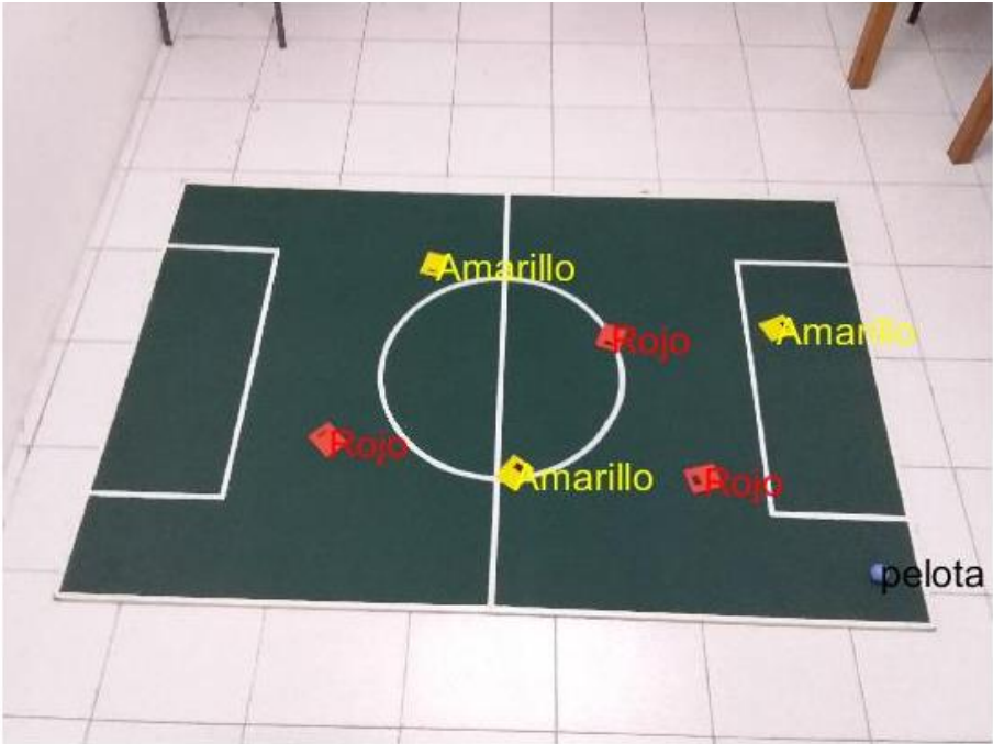
Figura 9. Detección de objetos con sus respectivos colores dentro del área de trabajo.
