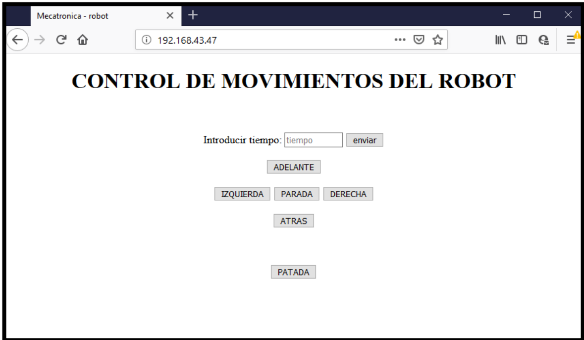
Figura 34. Diseño de página web con botones y formulario para control de los movimientos del robot durante un tiempo específico.
