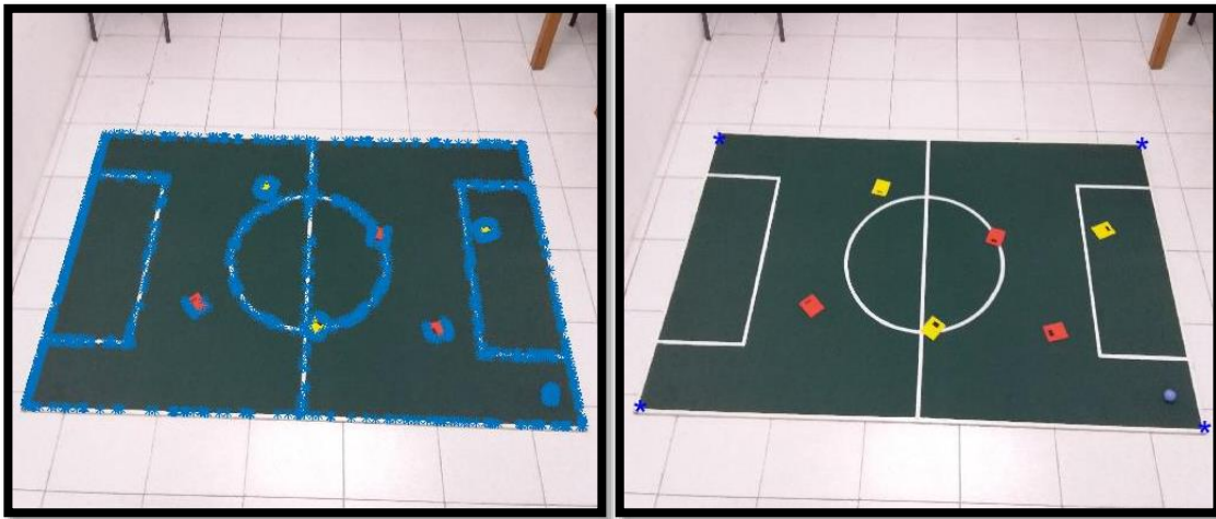
Figura 10. Búsqueda de las cuatro esquinas de la cancha por el método de Harris con un valor de 1200 esquinas.
