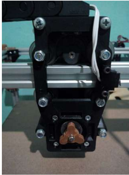
Figura 5.9: Ensamblaje real del carro deslizador del eje X que tiene integrado el sistema de intercambio de herramienta.
