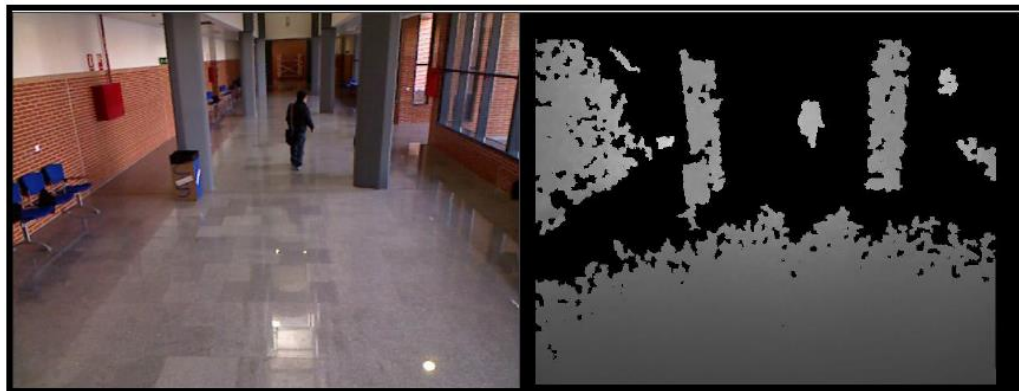
Figura 23. Imagen de profundidad para distancias muy grandes (Juan E. Salvatore, 2014 Guayaquil, Ecuador.)
