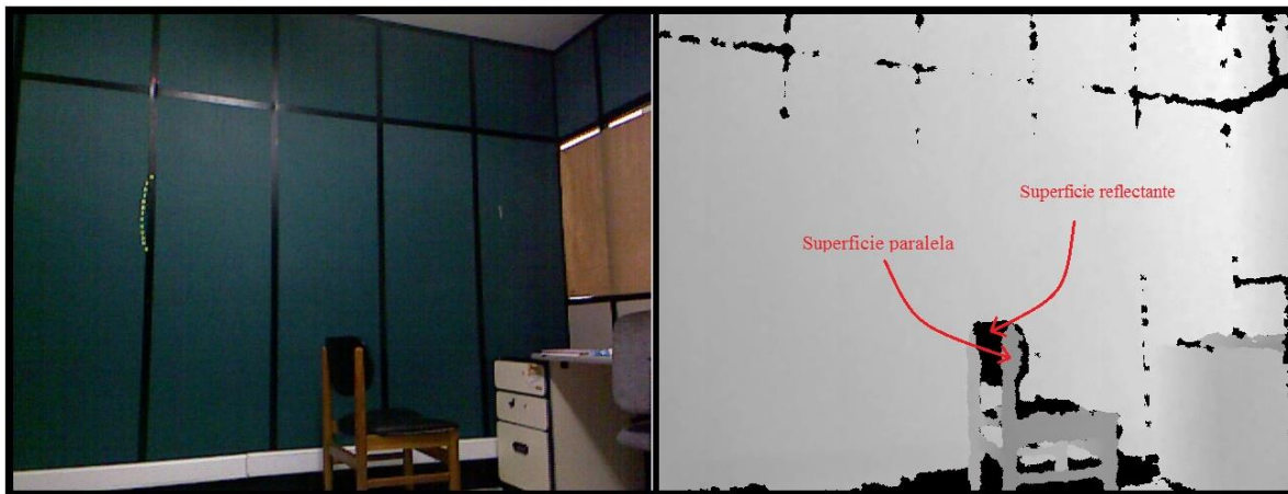
Figura 24. Efecto de superficie reflectante y paralela a los rayos de luz.
