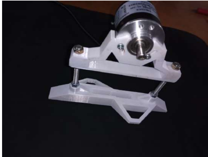
Figura 6.2: Acople y soporte del encoder impresos en 3D
