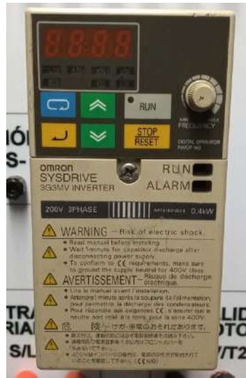
Figura 5.3: Variador de Frecuencia Omron SYSDRIVE 3GMV INVERTER
