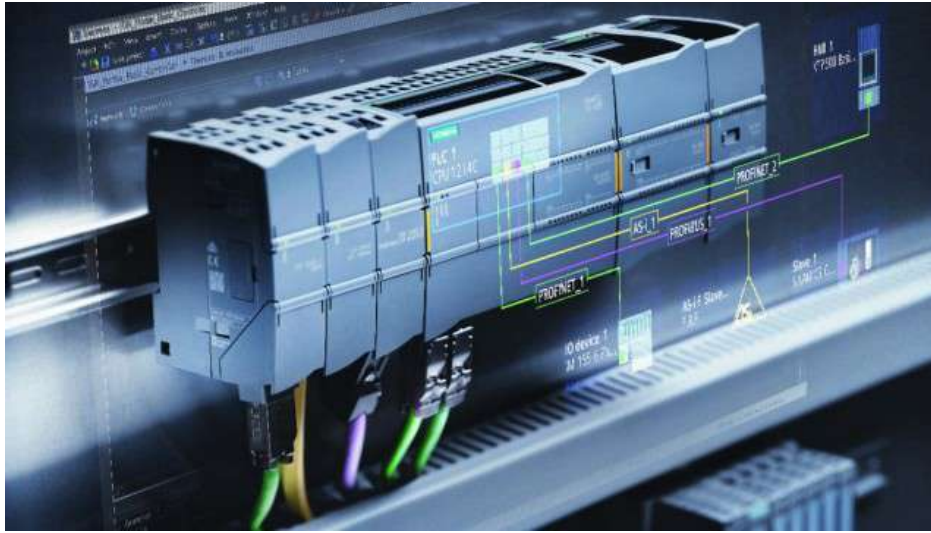
Figura 4.10: Controlador lógico programable (PLC)
