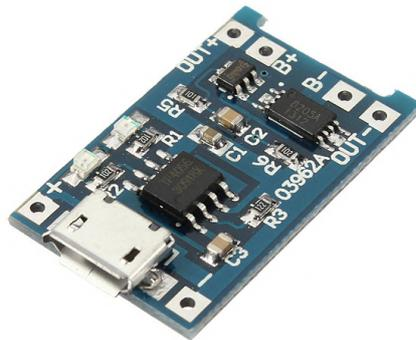
**Figura 3.6:** Módulo de carga TP4056
