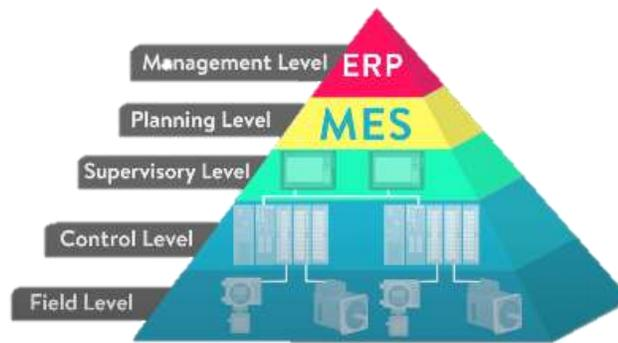
**Figura 24** Niveles jerárquicos y sus funciones en un sistema automatizado [31]
