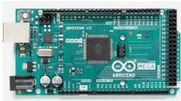
*Nota.* La gráfica muestra un Arduino mega 2560 Adaptado de (<https://store.arduino.cc/usa/mega-2560-r3>)
