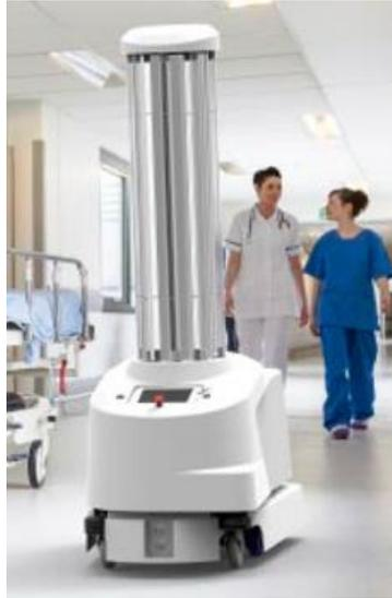
*Nota.* La gráfica muestra el robot móvil UVD para la desinfección por radiación ultravioleta de tipo c, de salas y superficies. Adaptado de ([www.hospitecnia.com](http://www.hospitecnia.com))
