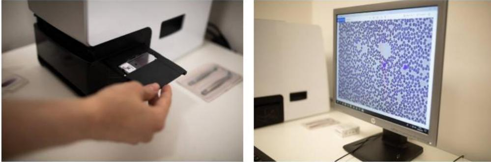
*Nota.* La gráfica muestra el sistema SomData basado en Machine Learning para la detección de protozoos en el agua. Adaptado de (<https://valenciaplaza.com/som-data-escaner-deteccion-microorganismos-agua>).
