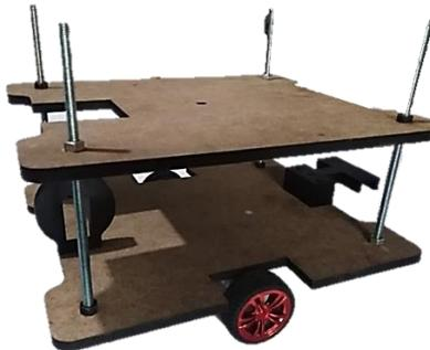
*Nota.* La gráfica muestra el ensamblaje de la primera y segunda sección que conforma el robot. Autoría propia.
