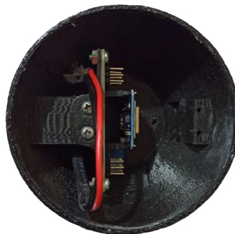
Figura 3.15: PCB ubicada dentro de una de las piezas de la mano robótica.
