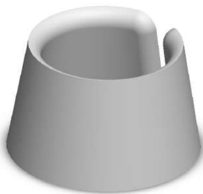
Figura 3.8: Modelo 3D de la base de la mano robótica.
