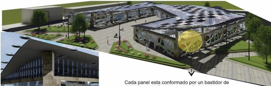
Cada panel esta conformado por un bastidor de aluminio con refuerzos y espaciadores de acero inoxidable para ruptura del puente termico
