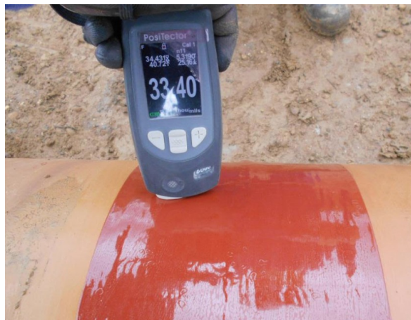
Figura 6.5: Toma de medida de espesor de película seca Fuente: UT VRO / ECP
