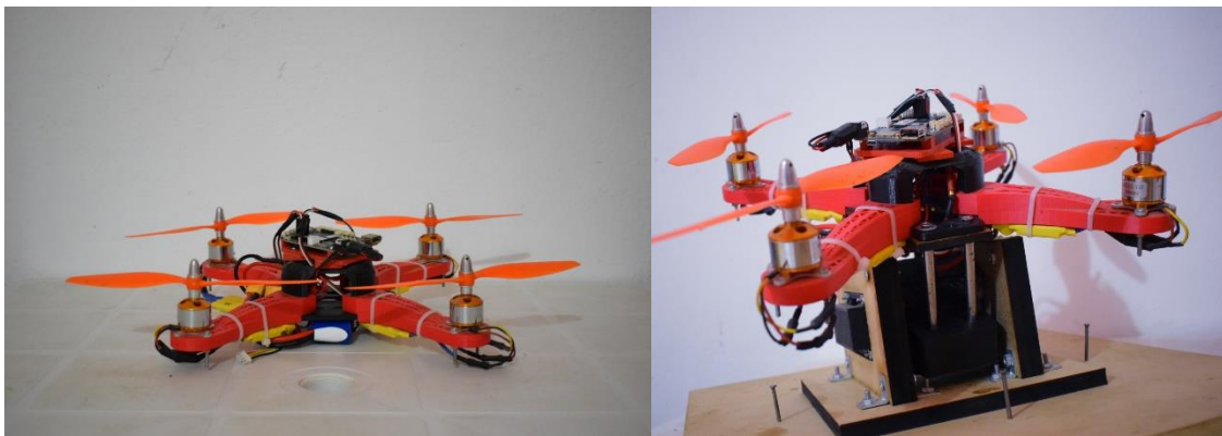
Ilustración 97 Drone en plataforma de 2gdl. Fuente: Autor.
