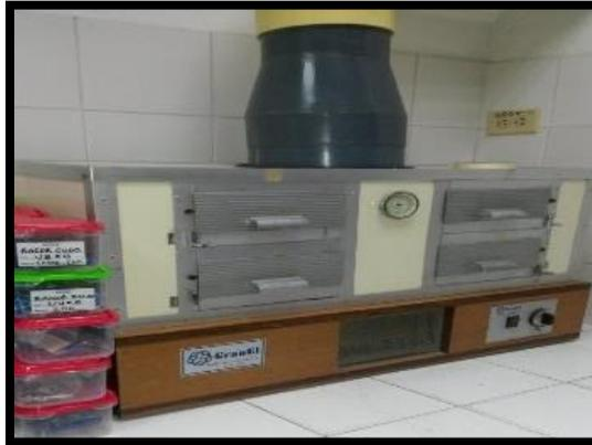
*Ilustración 18. Secador de 4 puestos.(Molinos el Yopal Ltda, 2016)*
