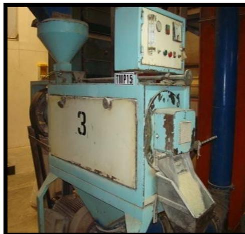
Ilustración 15. Polinchadora Horizontal.(Molinos el Yopal Ltda, 2016)
