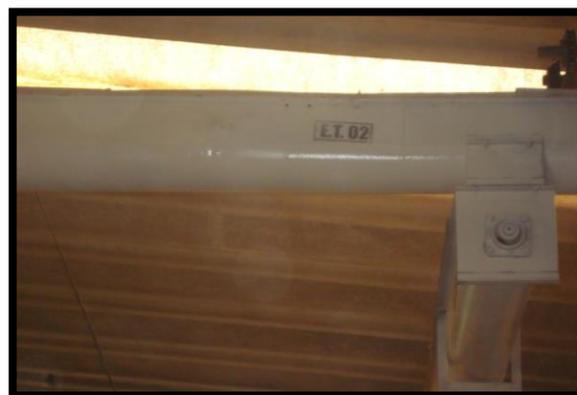
*Ilustración 83. Transportador sin fin para transporte de producto terminado.(Molinos el Yopal Ltda, 2016)*
