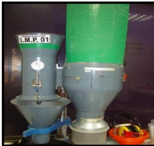
*Ilustración 11. Aspirador de Impurezas. (Molinos el Yopal Ltda, 2016)*
