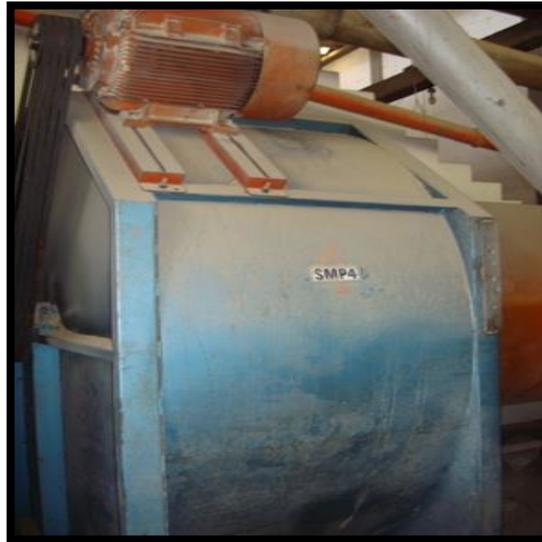
*Ilustración 29. Horno a gas. (Molinos el Yopal Ltda, 2016)*
