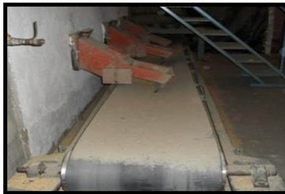
*Ilustración 81. Banda transportadora de albercas paddy seco. (Molinos el Yopal Ltda, 2016)*
