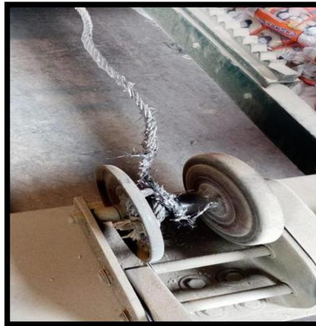
*Ilustración 82. Deterioro de guaya de banda transportadora. Autor*
