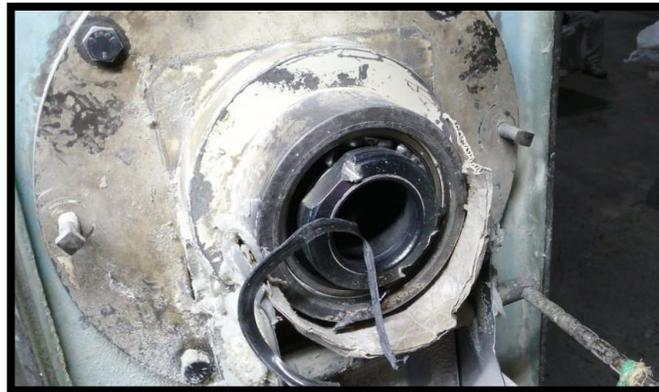
*Ilustración 61. Daño de Rodamiento 6215-2Z/C3 Polinchadora horizontal. Autor*
