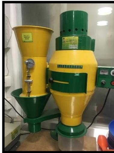
*Ilustración 26. Aspirador de Impurezas. (Molinos el Yopal Ltda, 2016)*
