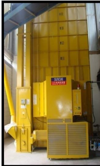
*Ilustración 31. Secadora de Torre. (Molinos el Yopal Ltda, 2016)*
