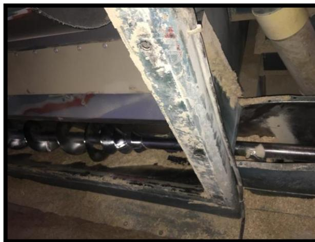
*Ilustración 55. Daño presentado en el transportador sin fin Ciclo Aventadora. Autor*
