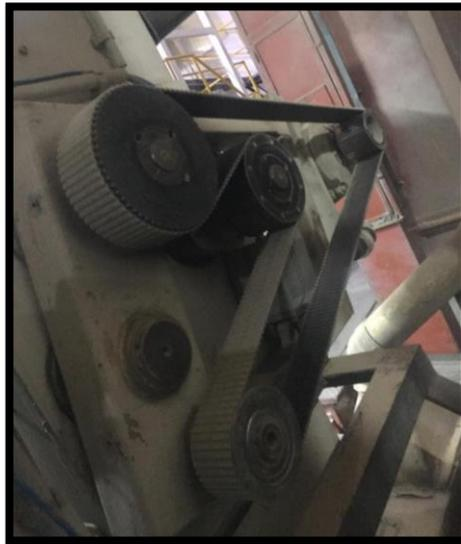
*Ilustración 52. Ajuste correa de la polea Descascarador Área trilla. Autor*
