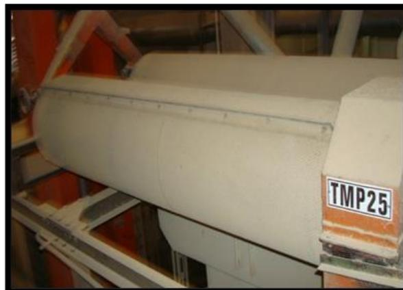
*Ilustración 63. Clasificador Horizontal TRIEUR. (Molinos el Yopal Ltda, 2016)*
