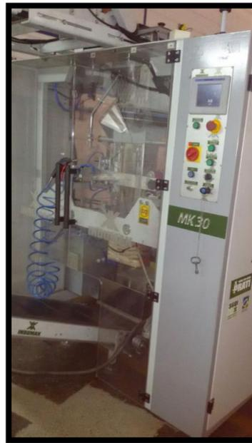
*Ilustración 76. Máquina Envasadora vertical electroneumática. (Molinos el Yopal Ltda, 2016)*
