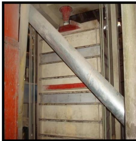
*Ilustración 64. Clasificador Vertical Plansifter. (Molinos el Yopal Ltda, 2016)*
