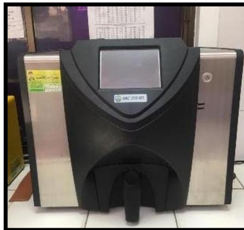
Ilustración 14. Determinador de Humedad GAC 2500. (Molinos el Yopal Ltda, 2016)
