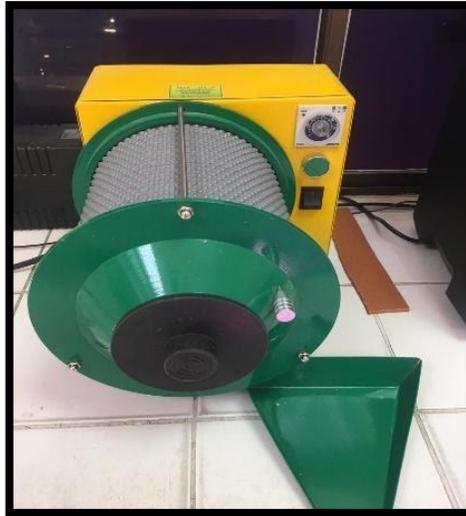
*Ilustración 12. Cilindro Clasificador.(Molinos el Yopal Ltda, 2016)*
