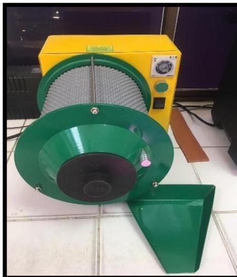
Ilustración 25. Cilindro Clasificador..(Molinos el Yopal Ltda, 2016)
