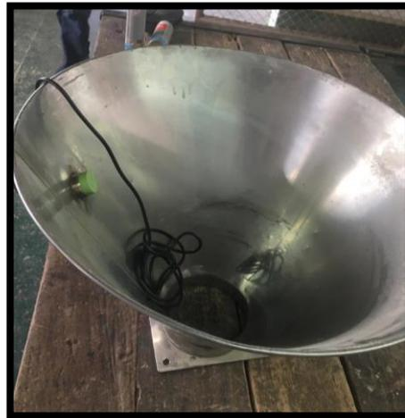
*Ilustración 77. Instalación de sensor capacitivo CR30. Autor*
