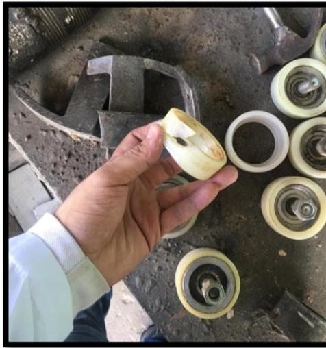
*Ilustración 58. Teflones fabricados y deteriorados que son usados en Clasificador de pepa. Autor*
