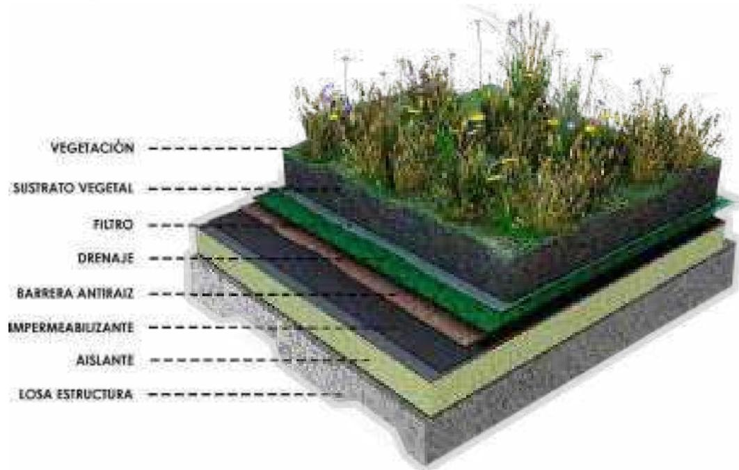
Ilustración 145: Detalle cubierta vegetal.
