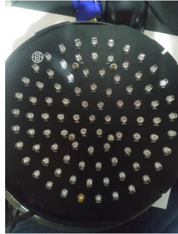
Figura 2. Matriz de leds, Estructura de una matriz de leds en módulo de 8".
