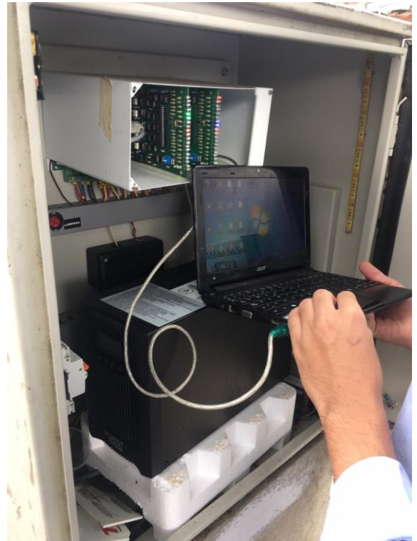
Figura 34. Configuración y mantenimiento, Conexión para la verificación del estado de la maquina
