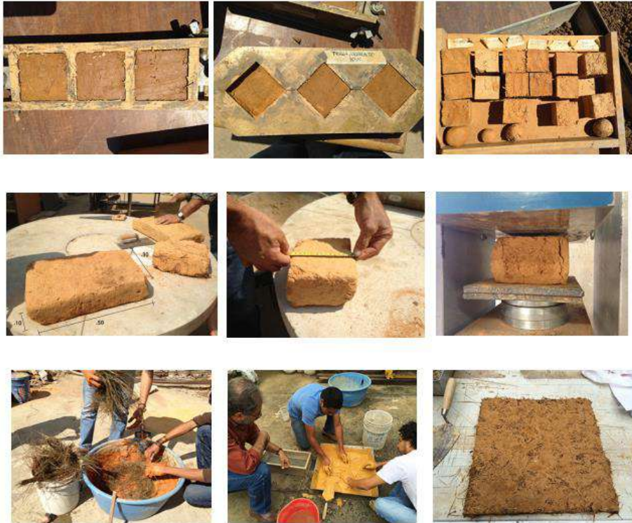
Ilustración 35 Pruebas técnicas hechas de adobes de la comunidad y pruebas de “pajarcillas” (combinación de arcilla con paja)
