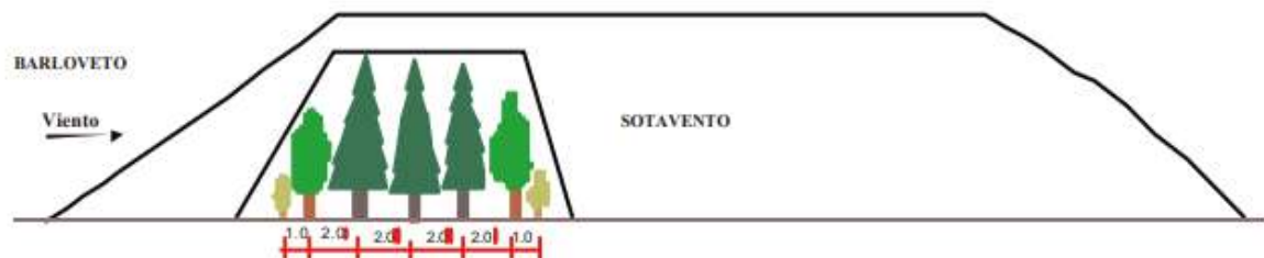
Ilustración 20 Formación correcta y zona de protección de una cortina
