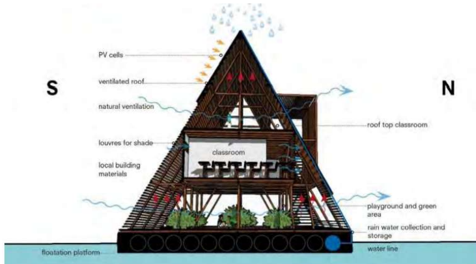
Ilustración 2-10. Sección transversal de la escuela.
