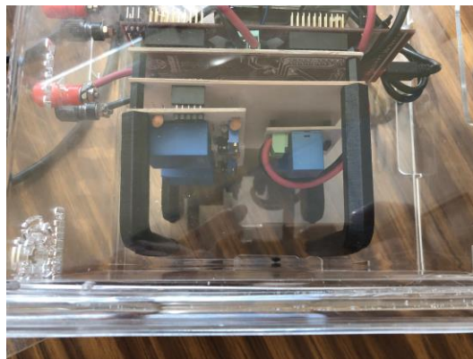
Figura 6.4.12. Vista acercada de los soportes de la electrónica impresos en 3D Di Pr.
