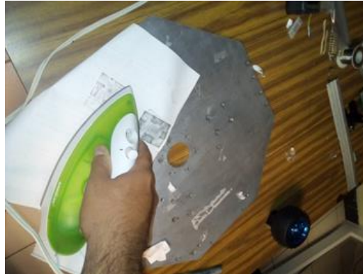
Figura 6.4.2. Método de planchado para transferencia de las impresiones Di Pr.
