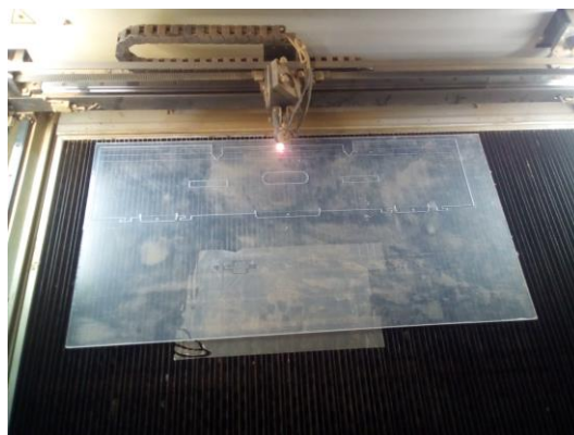
Figura 6.4.7. Estructura, corte laser CNC Di Pr.
