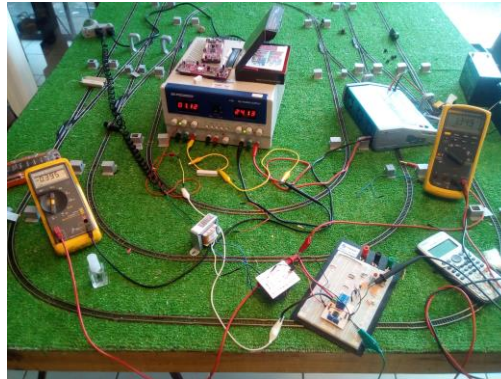
Figura 4.2.2. Caracterización del sensor de corriente Di. Pr.
