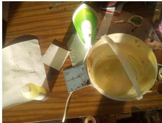
Figura 6.4.4. Abrasivo ( FeCl_3 ) aplicado para retirar el cobre sobrante Di Pr.
