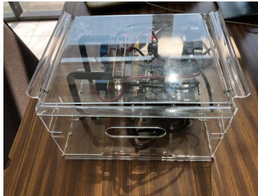
Figura 6.4.15. Vista trasera prototipo convertidor CD-CD "Buck-Boost" Di Pr.
