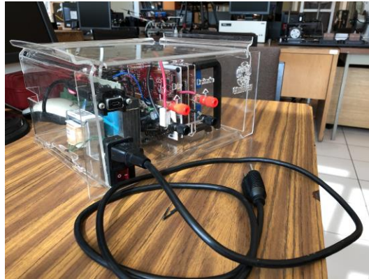
Figura 6.4.17. Vista diagonal izquierda del prototipo convertidor CD-CD "Buck-Boost" Di Pr.
