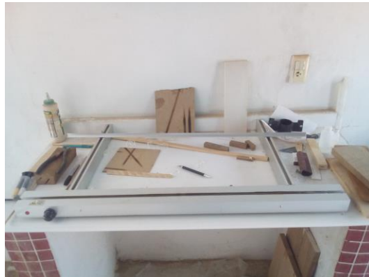
Figura 6.4.9. Herramienta, resistencia térmica para dobleces en acrílico Di Pr.
