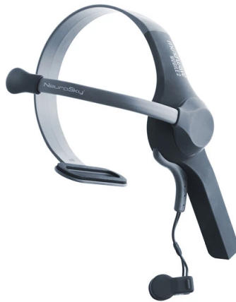
Figura 4.1: Ejemplo de dispositivo para el registro de la actividad cerebral. Fuente: NeuroSky, “MindWave Mobile 2” (2015). Disponible en: https://store.neurosky.com/
