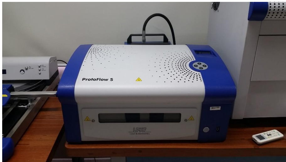
Figura 17: Máquina utilizada para soldar los componentes electrónicos a la PCB.
