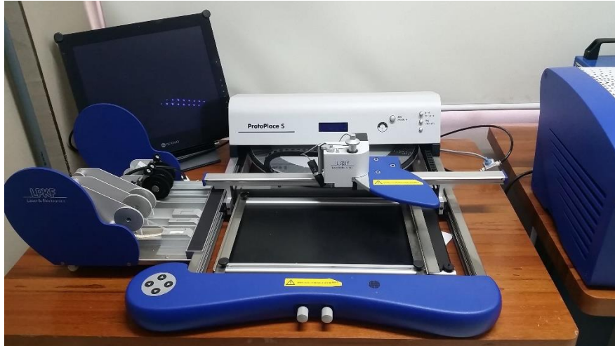
Figura 16: Máquina para la colocación de los componentes electrónicos en la PCB.
