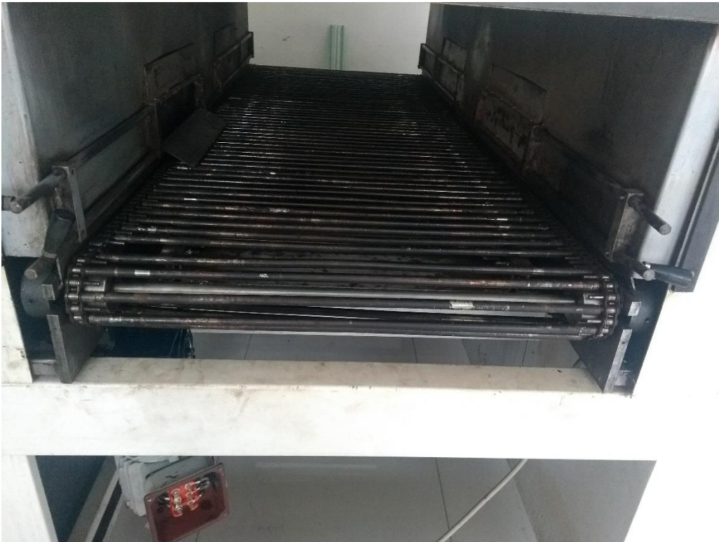
Figura 34. Motoreductor y sistema transportador de productos.
