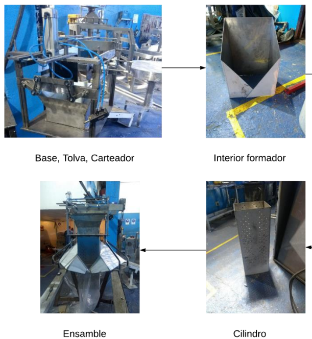
Figura 66. Proceso de fabricación del conjunto formador.
