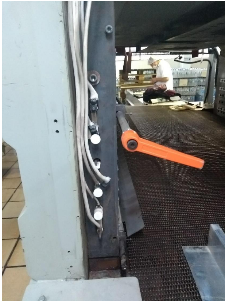
Figura 25. Instalación de resistencias.
