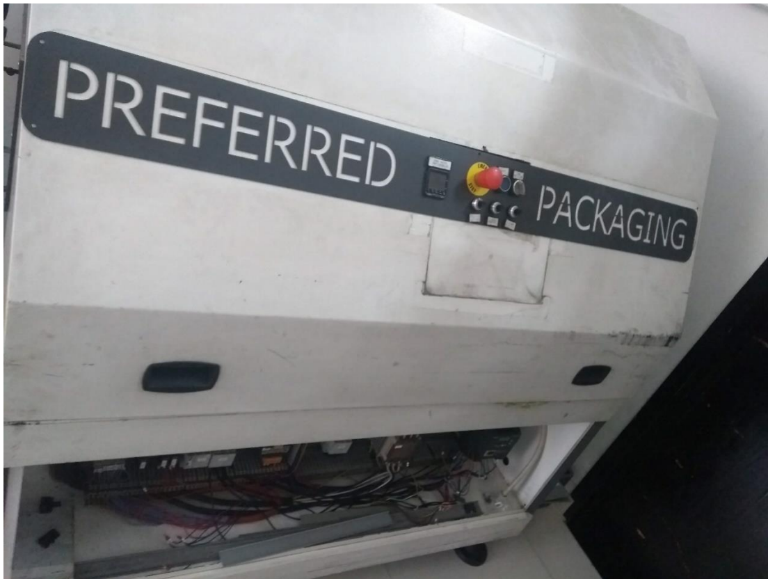
Figura 32. Túnel de retracción de Universal Pack Group.
