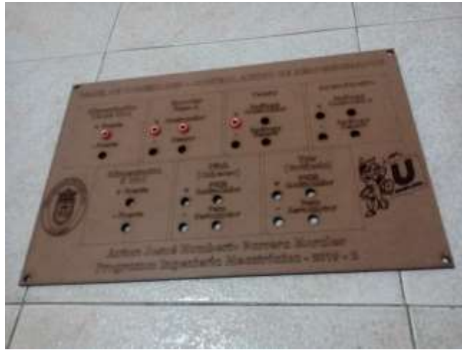
Figura 88. Colocación de las bananas tipo hembra en el panel de conexiones [Autor]
