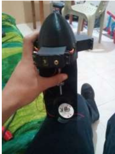
Figura 86. Armado de la góndola con los actuadores y sensores [Autor]
