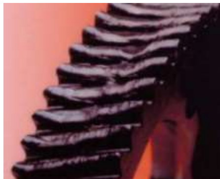
Figura 29. Fallo por deformación plástica [17]
