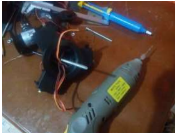
Figura 87. Cableado del rotor y los anillos deslizantes [Autor]
