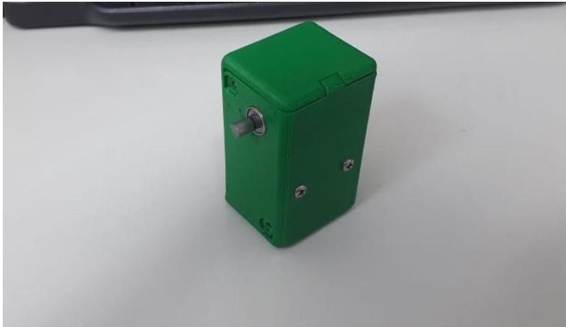
**Figura. 19.** Actuador robótico ensamblado para la realización de pruebas.
