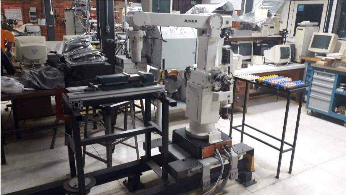
**Figura. 9.** Brazo robótico para trabajos de fresado de la empresa ASEA.
