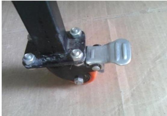
Figura 53. Roachines delanteros de la mesa ergonómica automatizada.
