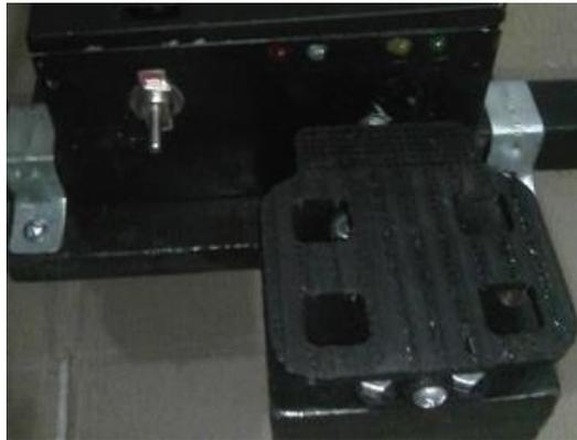
Figura 58. El pedal que controla el giro del motor.
