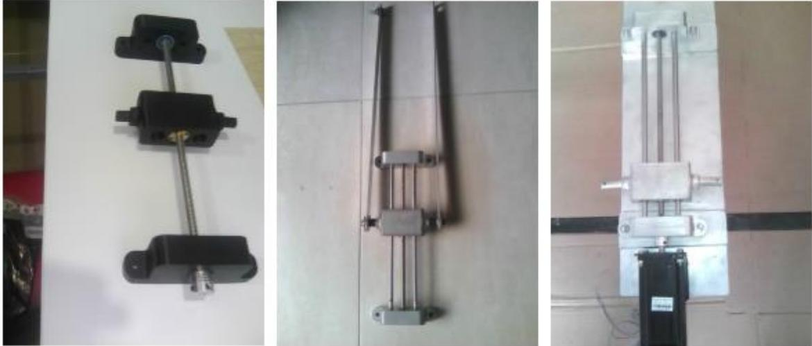
Figura 51. Construcción del soporte y mecanismo del tornillo sin fin.
