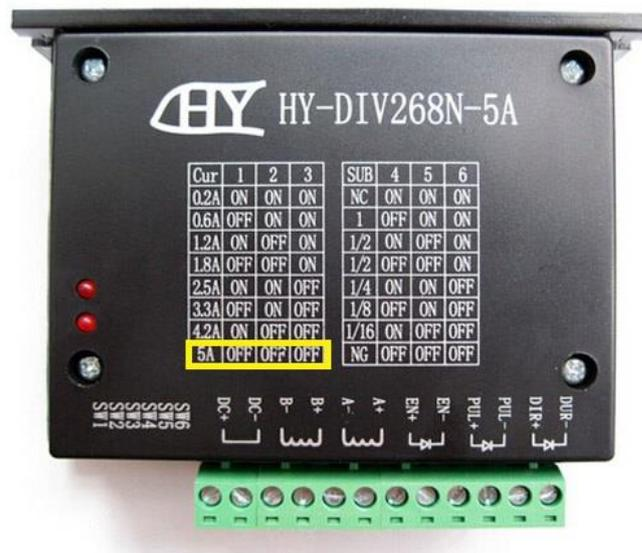
Figura 62. Configuración de corriente de driver.
