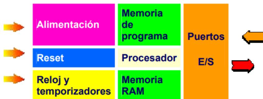
Figura 20. Representación esquemática de un microcontrolador.
