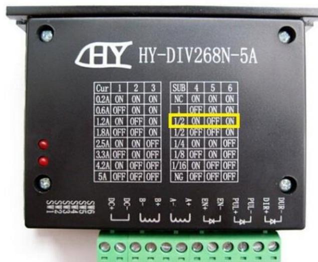
Figura 60. Configuración del driver HY-DIV268N-5A.
