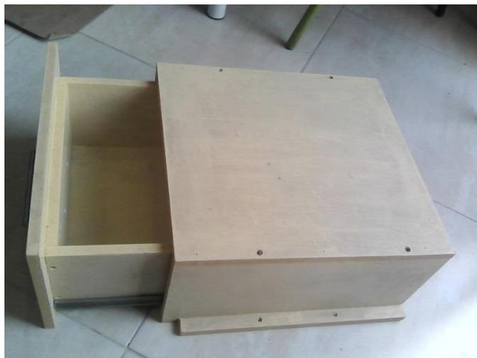
Figura 50. Construcción de la gaveta con sistema de rodamientos.
