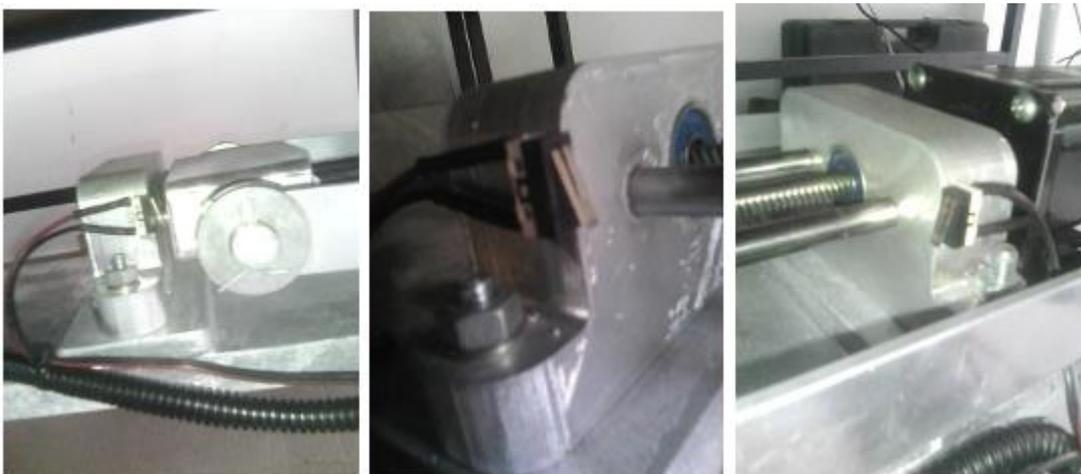
Figura 59. Finales de carrera en el tope mínimo y máximo del motor.
