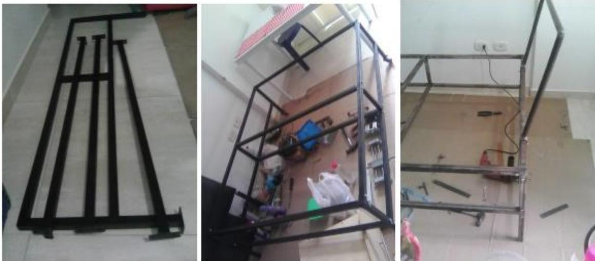
Figura 49. Construcción de la estructura metálica de la mesa ergonómica.
