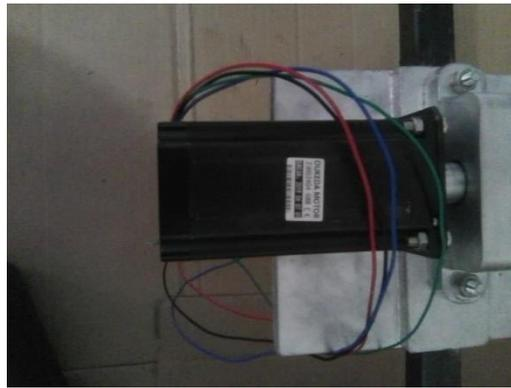
Figura 42. motor paso a paso nema 23.
